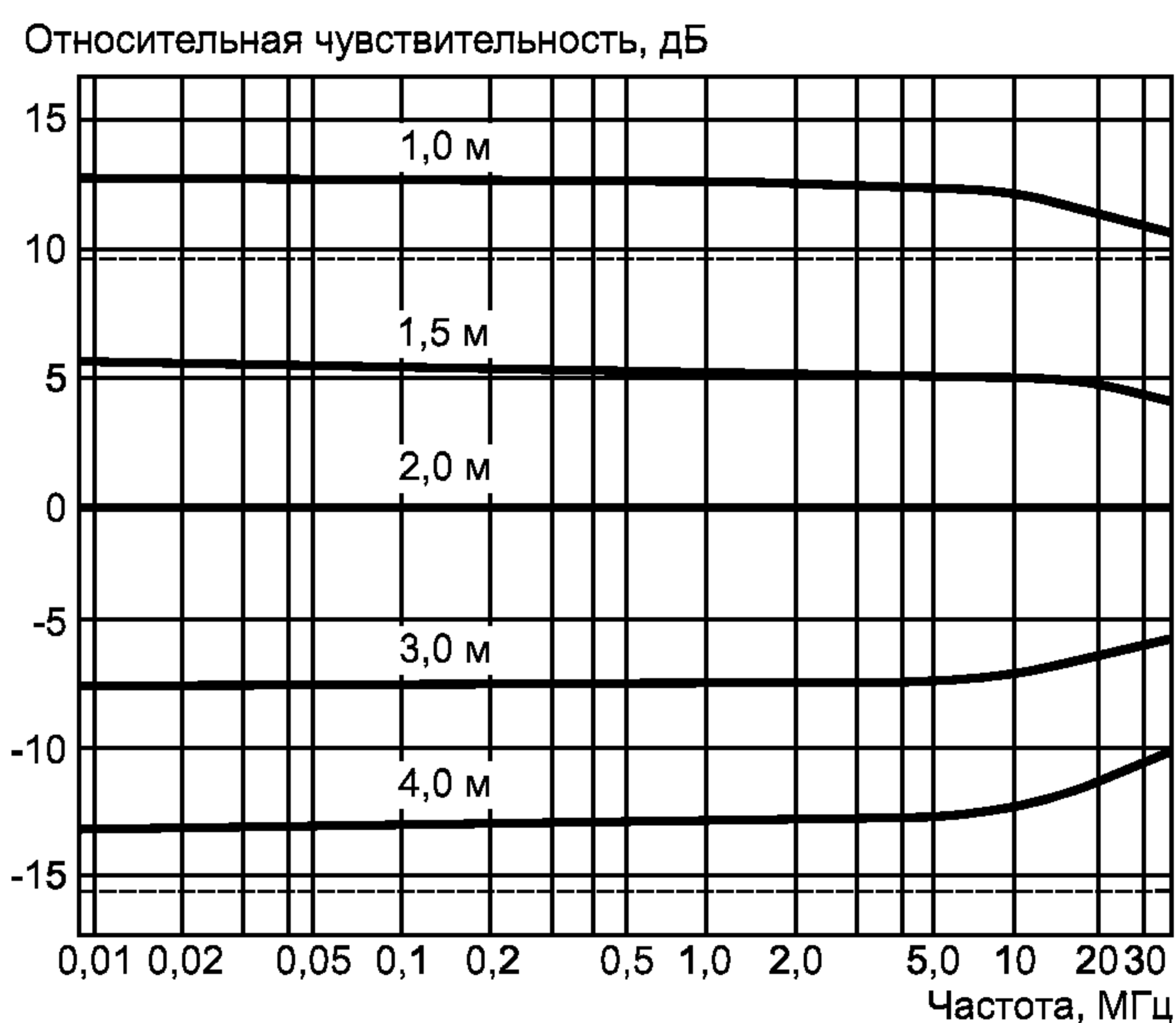
Рисунок С.11 — Чувствительность S_D большой рамочной антенны диаметром D относительно большой рамочной антенны диаметром 2 м
