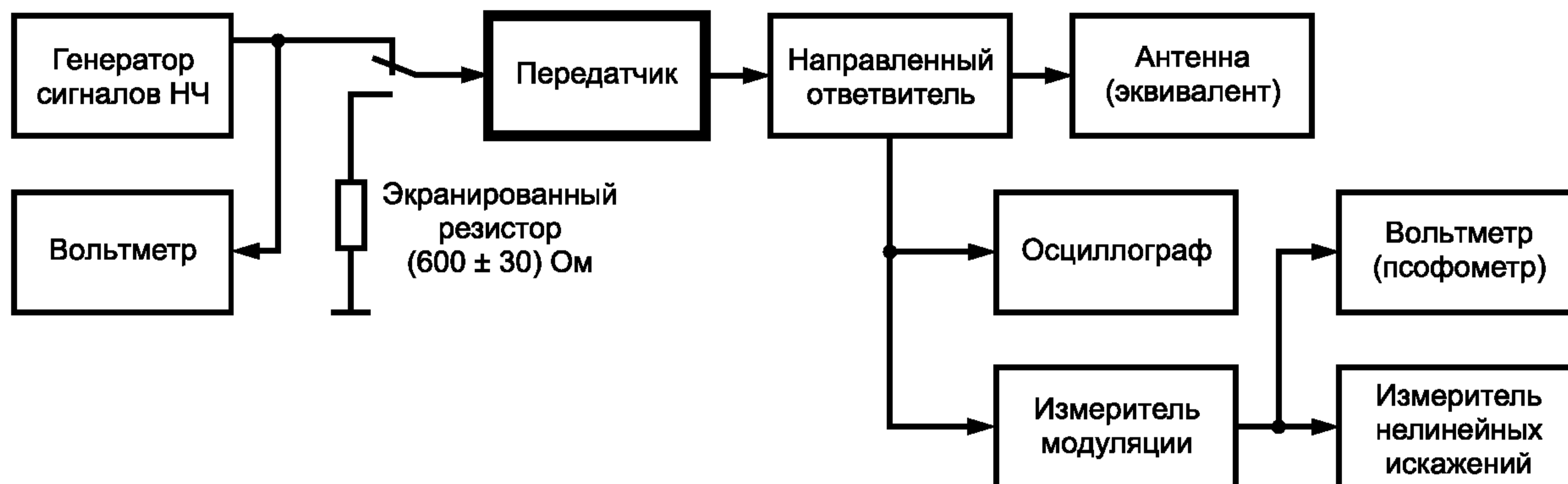
Рисунок 33 — Схема измерений неравномерности АЧХ, коэффициента гармоник, уровня невзвешенного и взвешенного шумов, пределов регулирования уровня входного сигнала
