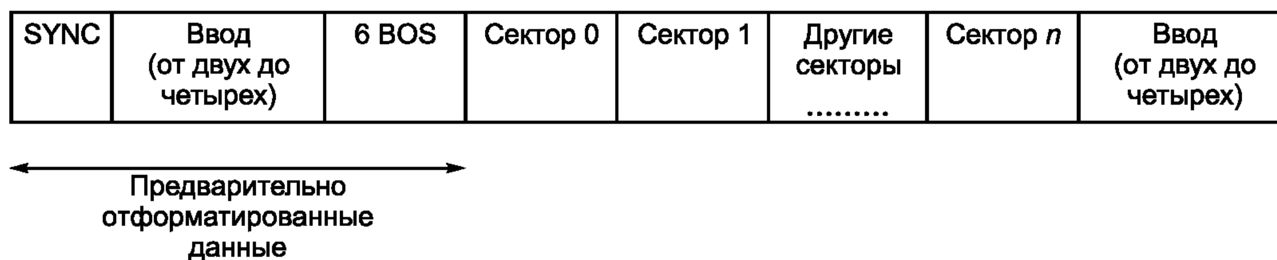
Рисунок В.5 — Структура полной дорожки, секторы типов 0—5
