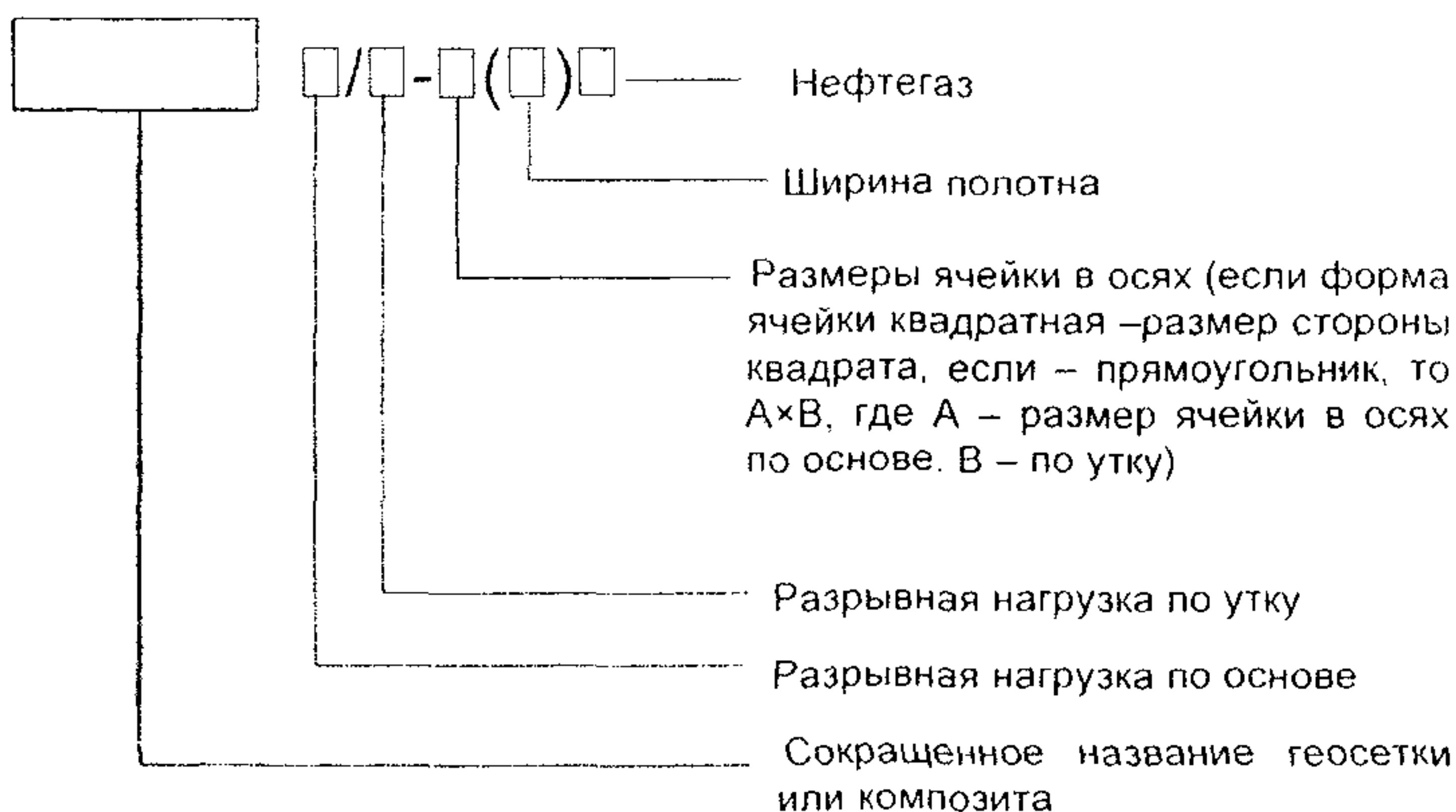
Пример условного обозначения сетки стеклянной нитепрошивной пропитанной с разрывной нагрузкой по основе 50 кН/м и по утку- 50 кН/м, с прямоугольным размером ячейки с размером по основе 25 мм и по утку- 30 мм, шириной полотна 400 см:
