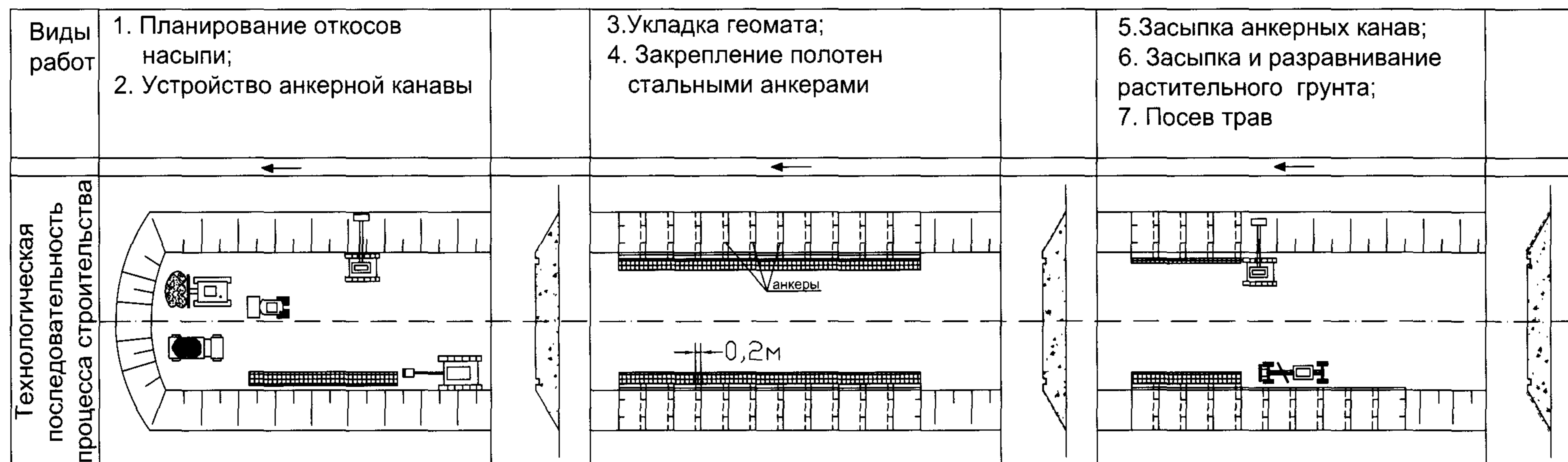
Технологическая схема укрепления откосов геоматами
