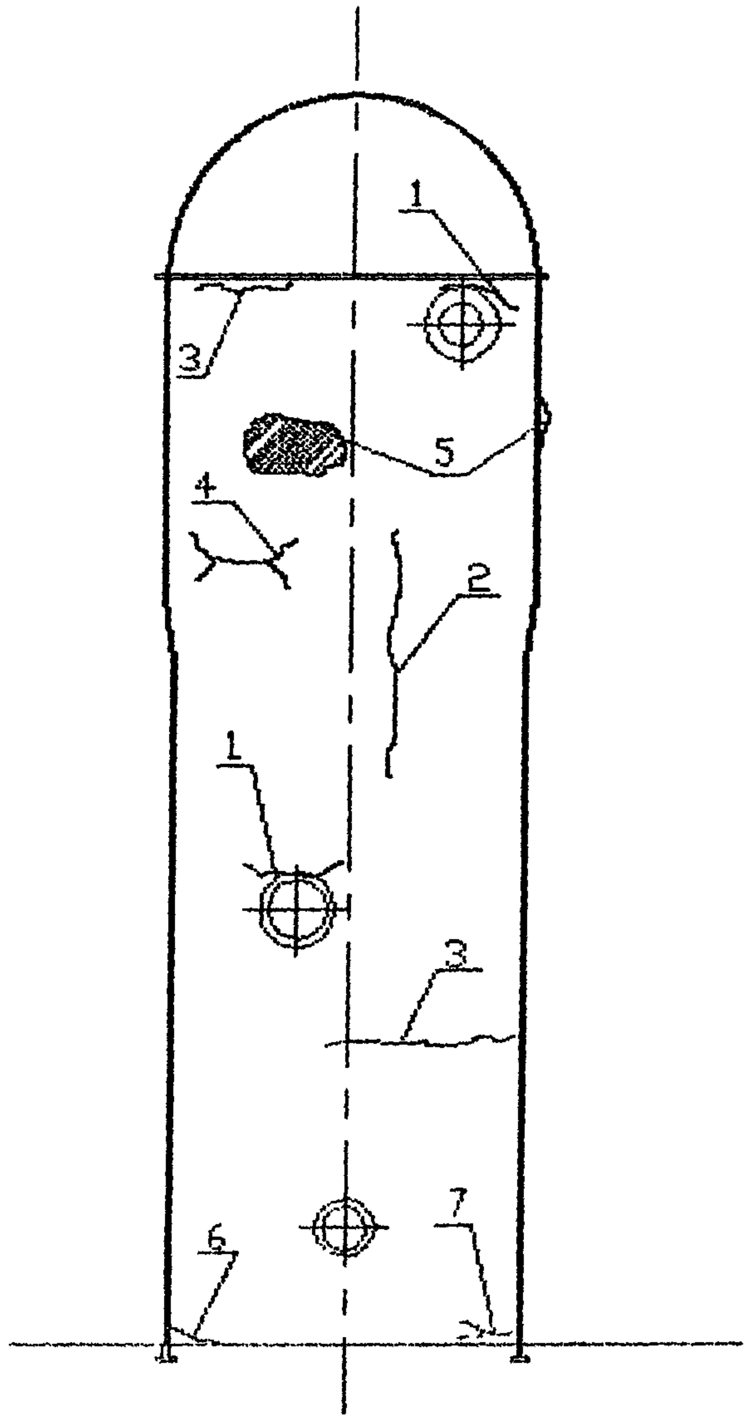
Рис.2. Повреждения кожуха воздухонагревателя.
