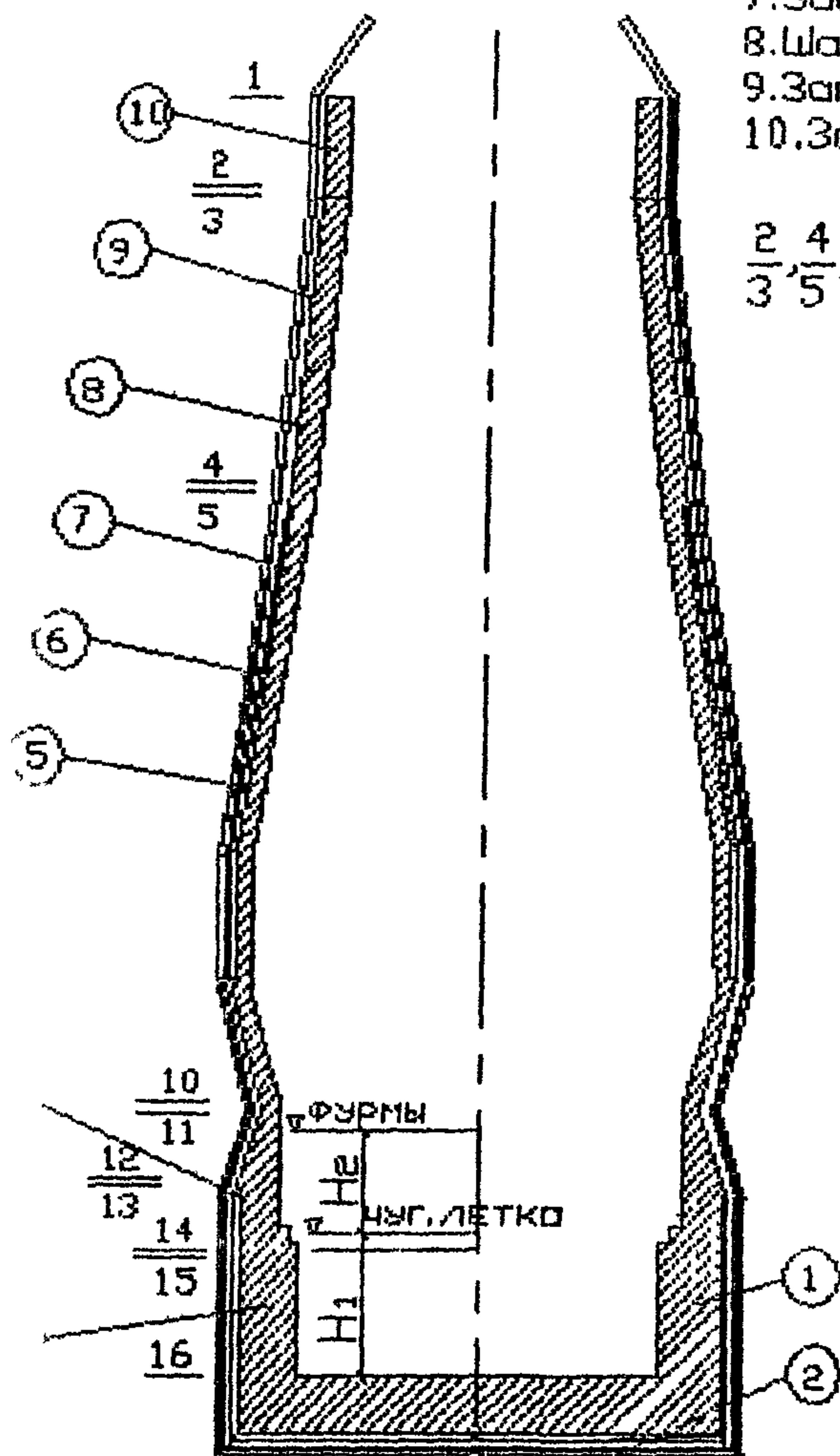
Рис.3. Расчетные сечения кожуха доменной печи.
