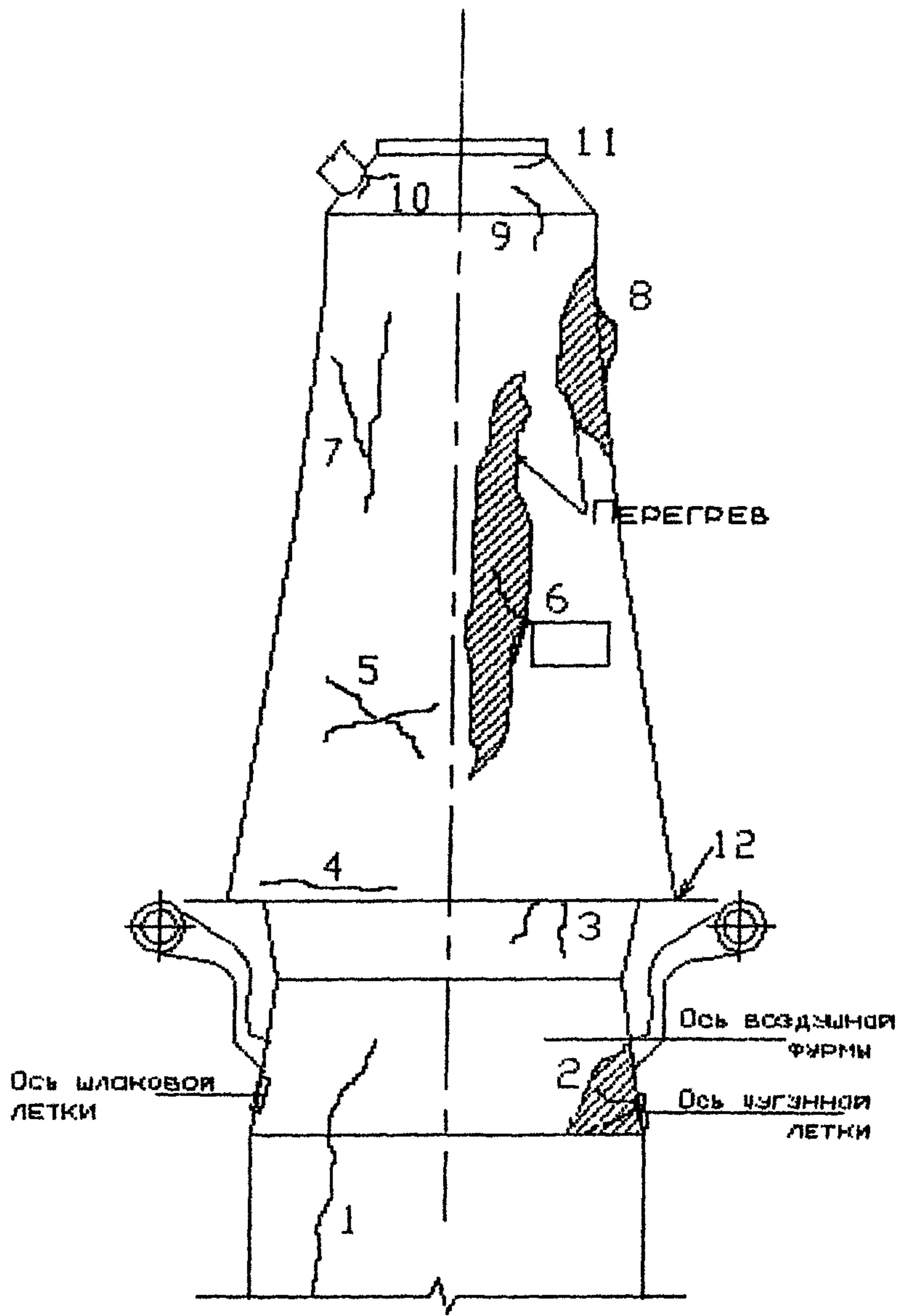
Рис.1. Повреждения кожуха доменной печи.
