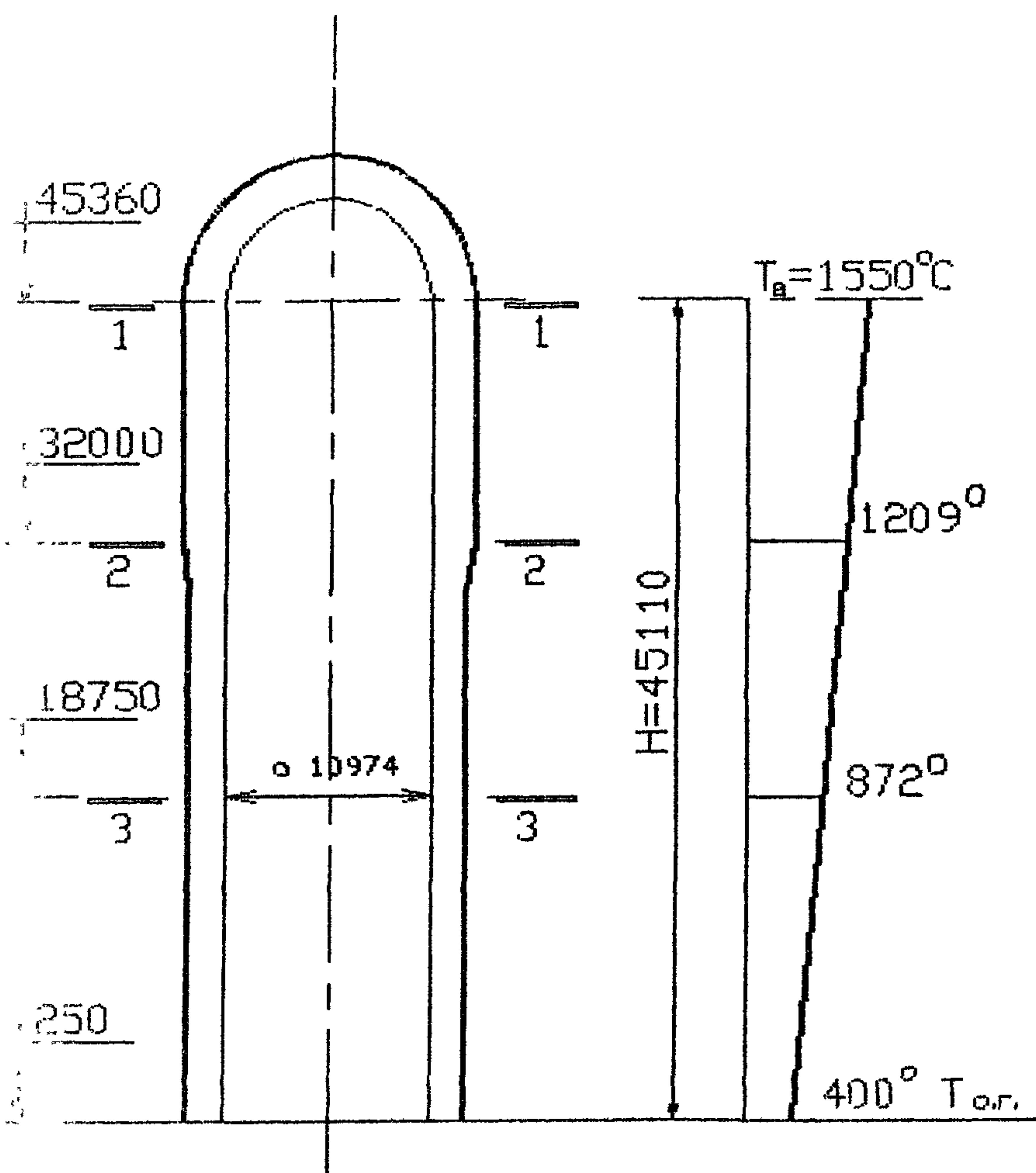
Рис.5. Расчетные сечения воздухонагревателя.
