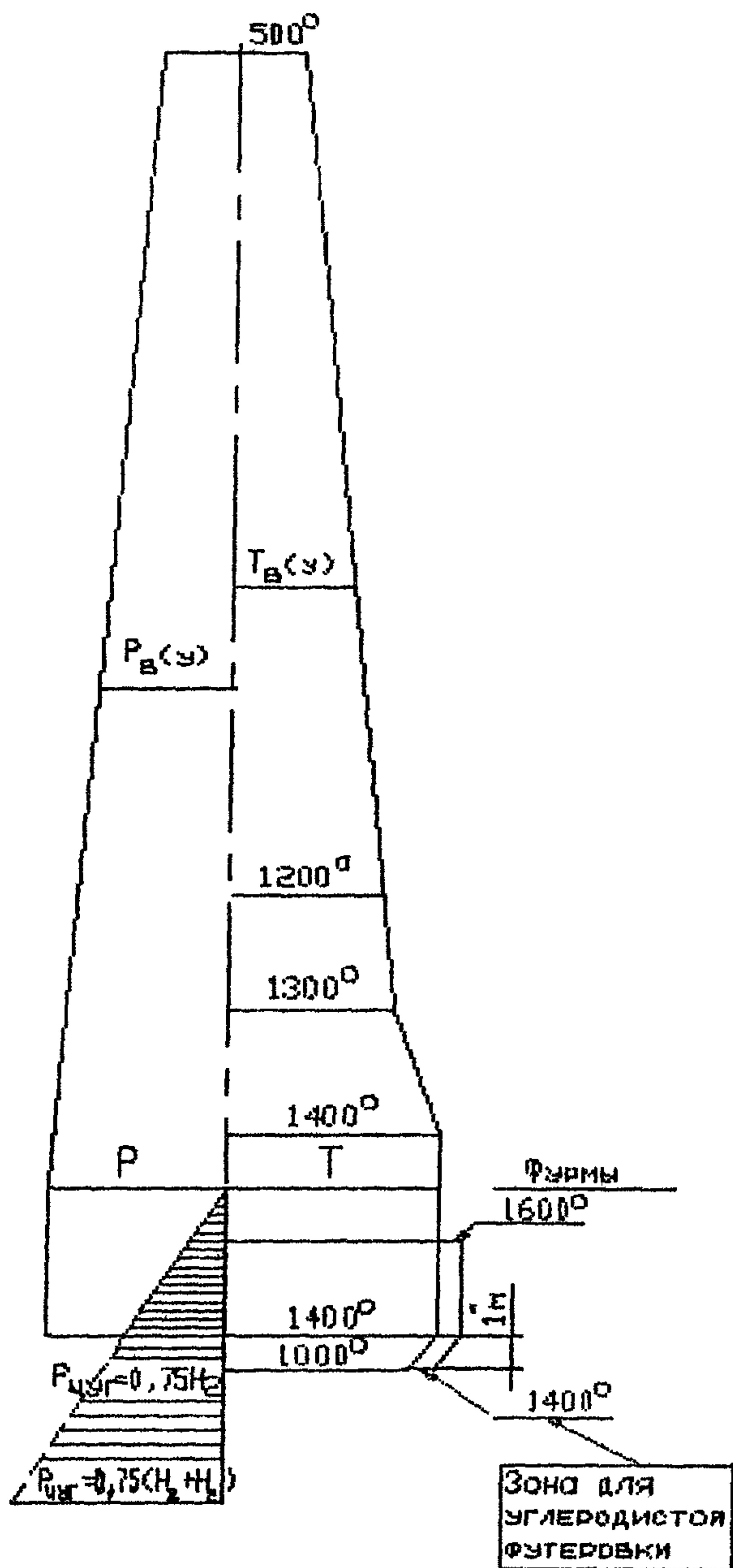
Рис. 4. Расчетная схема кожуха.
