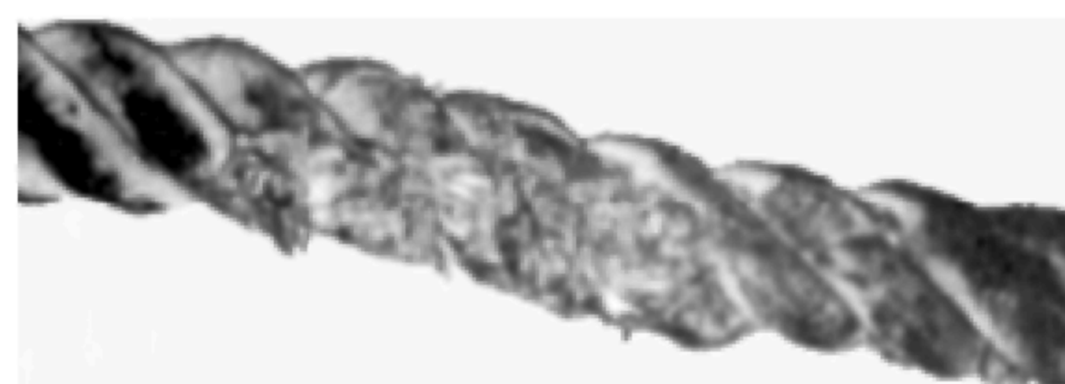
Рисунок С.11 — Механические повреждения
