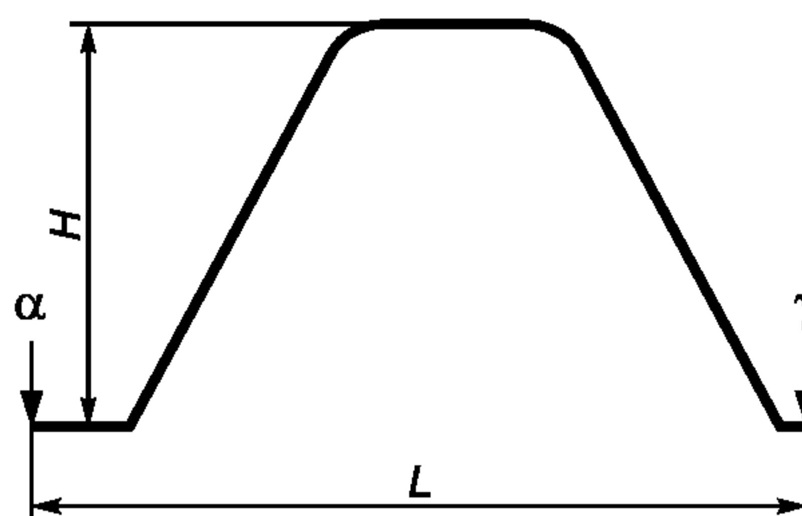
$\alpha$  — точка на видеопрофиле, соответствующая начальному положению зонда АСМ при сканировании;  $\gamma$  — точка на видеопрофиле, соответствующая конечному положению зонда при сканировании;  $H$  — высота выступа, измеренная по видеопрофилю;  $L$  — разность абсцисс конечной и начальной точек горизонтального сканирования, соответствующая величине горизонтального перемещения подвижной части рабочего стола АСМ, вычисленная по видеопрофилю
