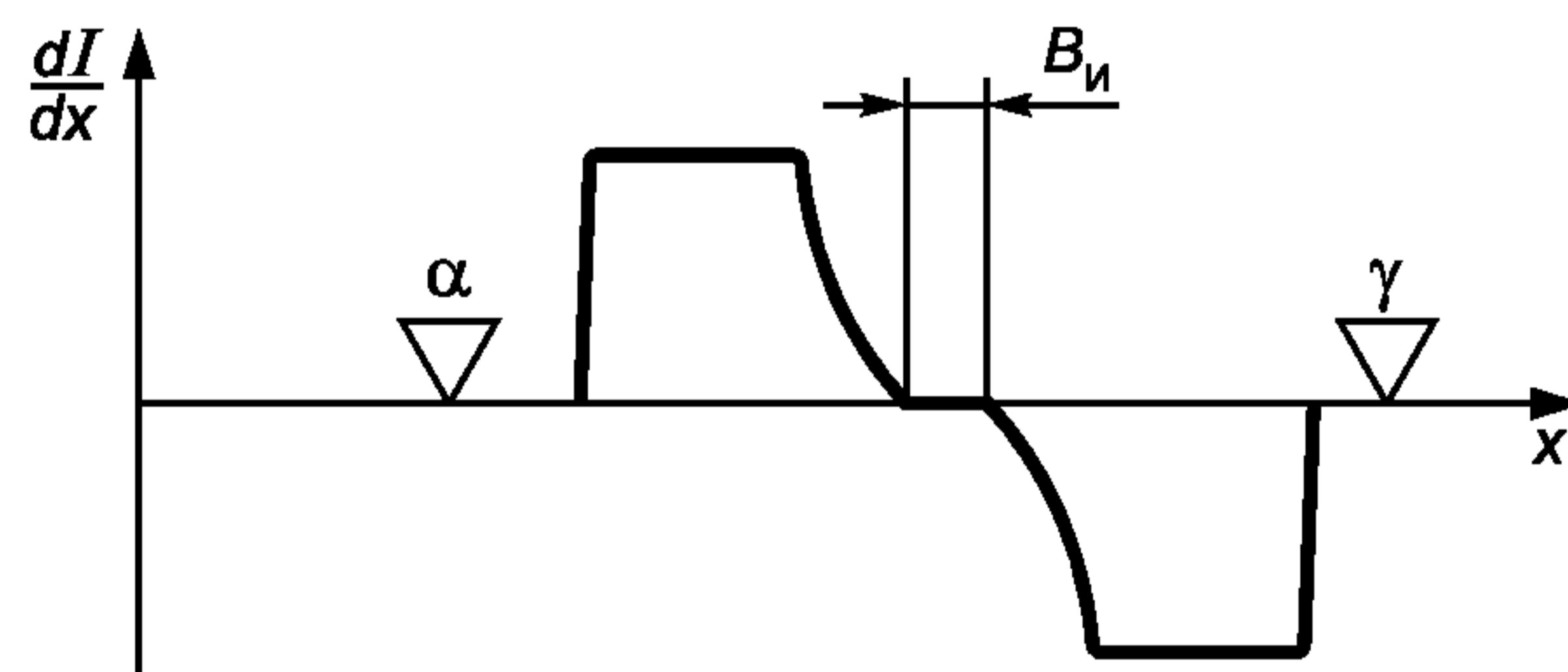
$x$  — ось абсцисс по 8.2.2;  $\alpha, \gamma$  — начальная и конечная точки положения зонда АСМ при сканировании поверяемого элемента, расположенные по 8.2.1;  $\frac{dI}{dx}$  — ось ординат по значению производной величины видеосигнала по координате  $x$ .
