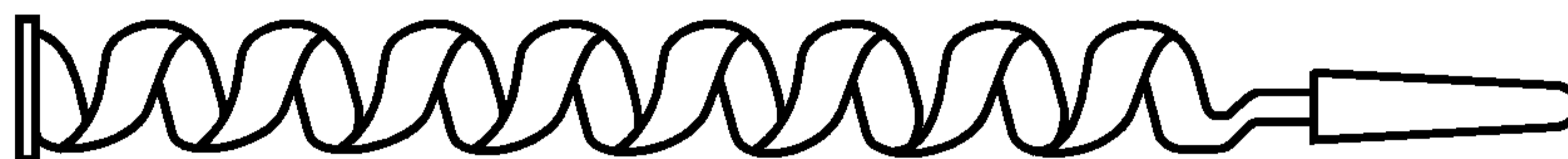
Рисунок 10 — Корабельный бур для отбора проб сверлением
