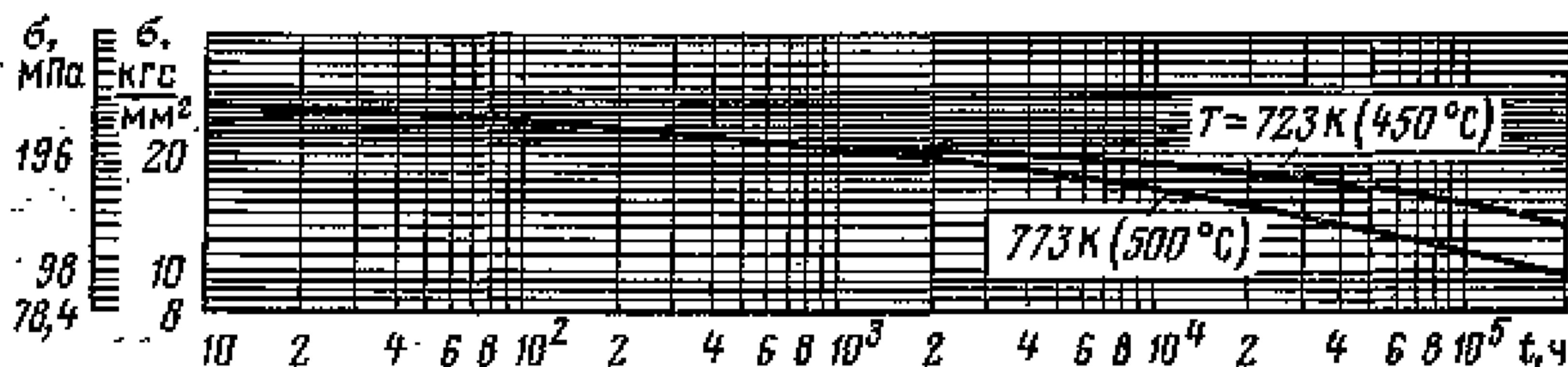
Рис. П6.6. Кривые длительной прочности стали марки 12X1MФ при различной температуре [ R_{p0.2}^{20} = 274 МПа (20 кгс/мм 2 ); R_m^{20} = 441 МПа (45 кгс/мм 2 )]
