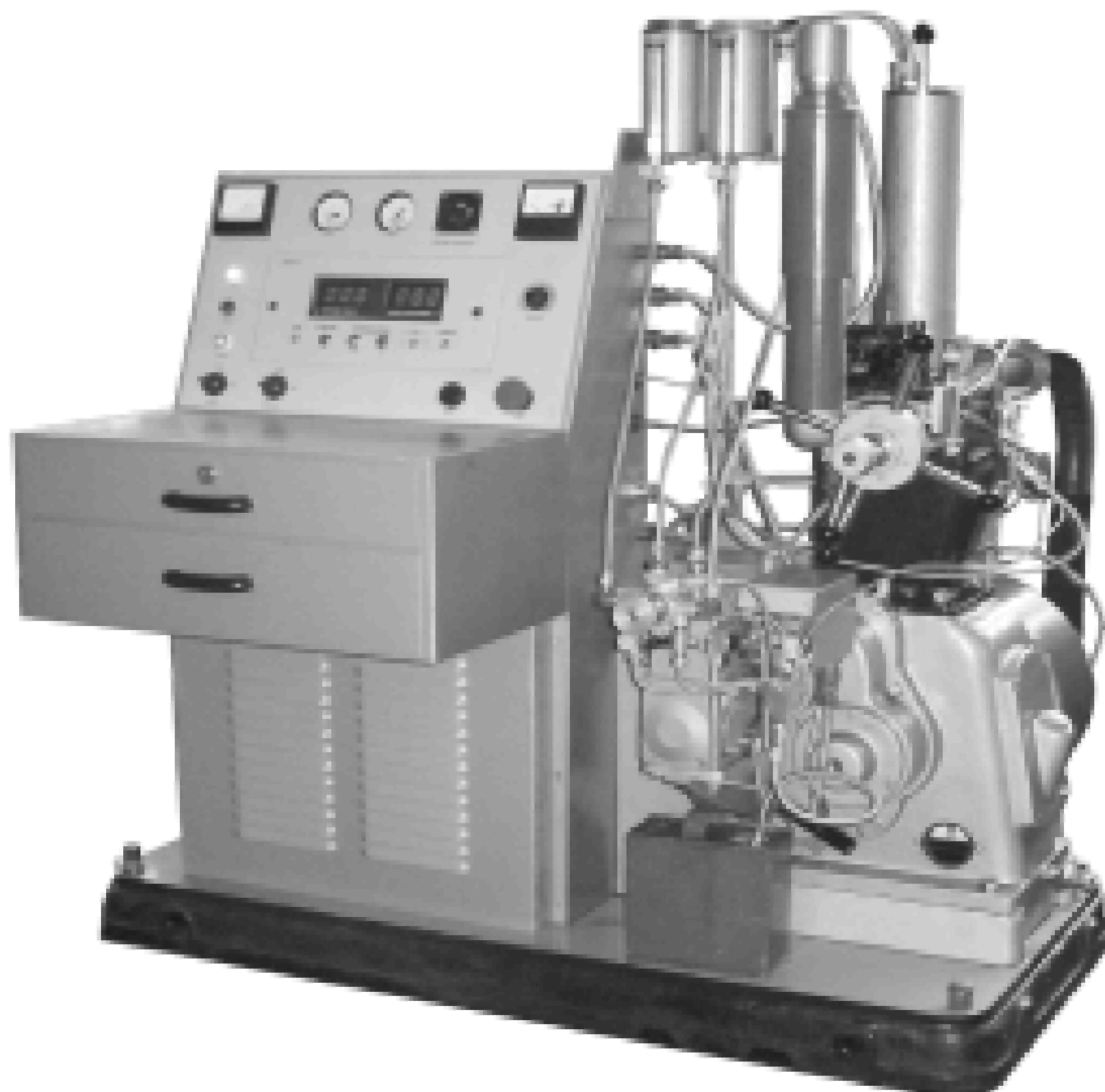
Рисунок 1 — Установка ИДТ-90 для определения цетанового числа
