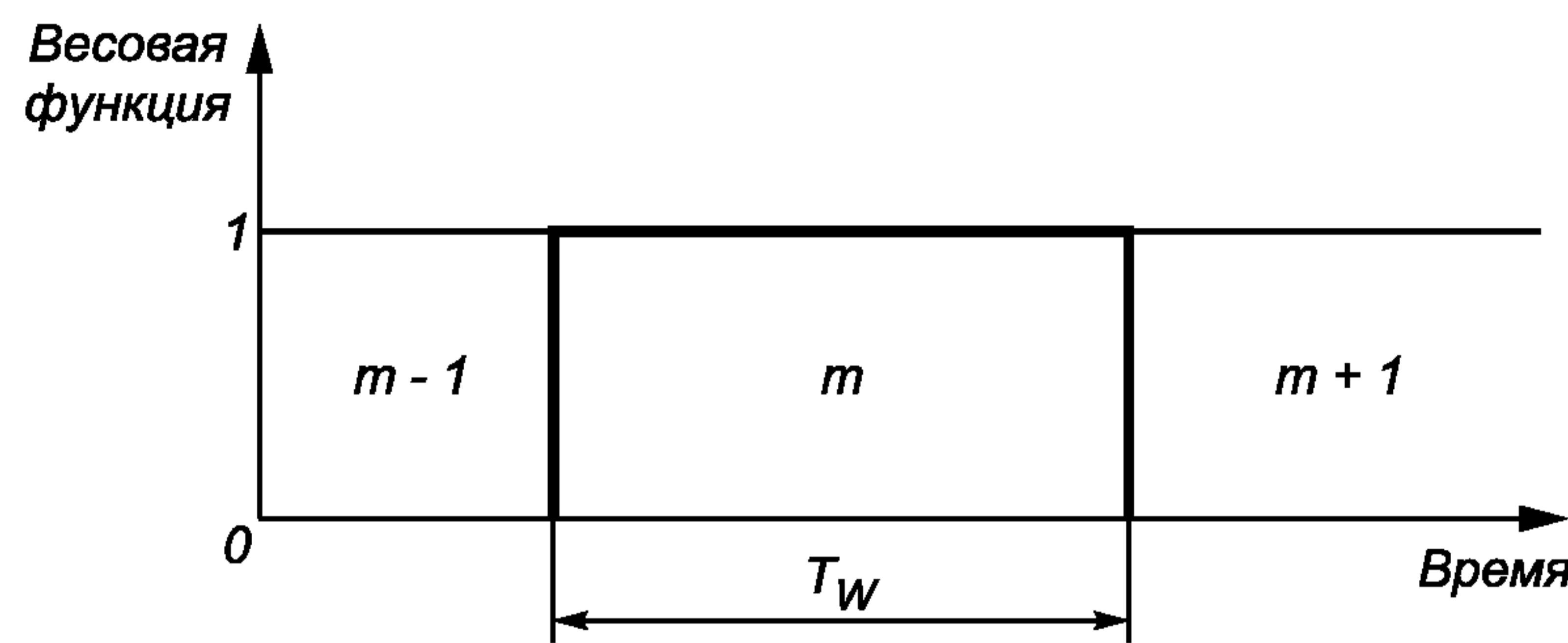
$m-1, m, m+1$  — последовательность измерительных окон;  $T_W$  — ширина измерительного окна
