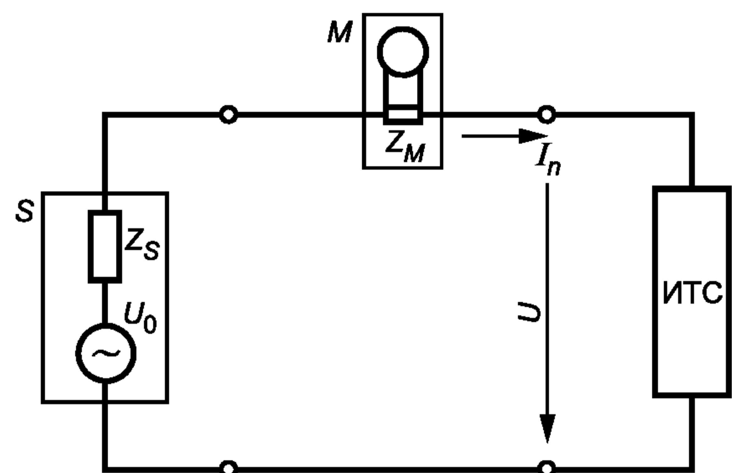
Рисунок А.1 — Схема измерений для однофазных ТС
