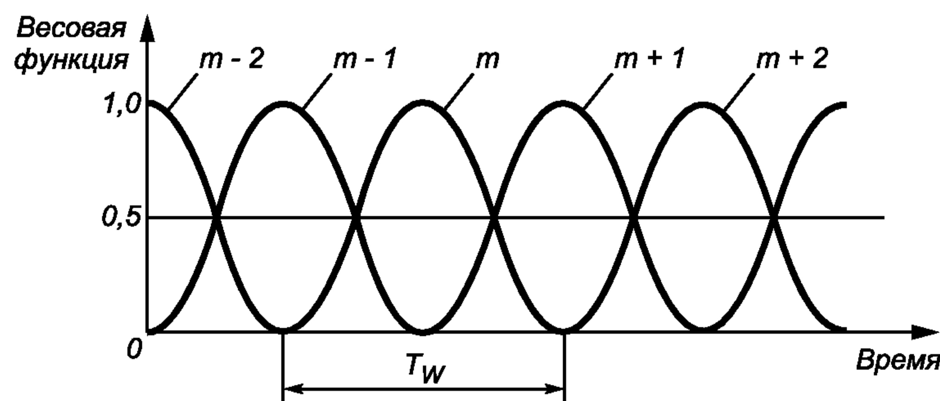
$m-2, m-1, m, m+1, m+2$  — последовательность измерительных окон;  $T_W$  — ширина измерительного окна
