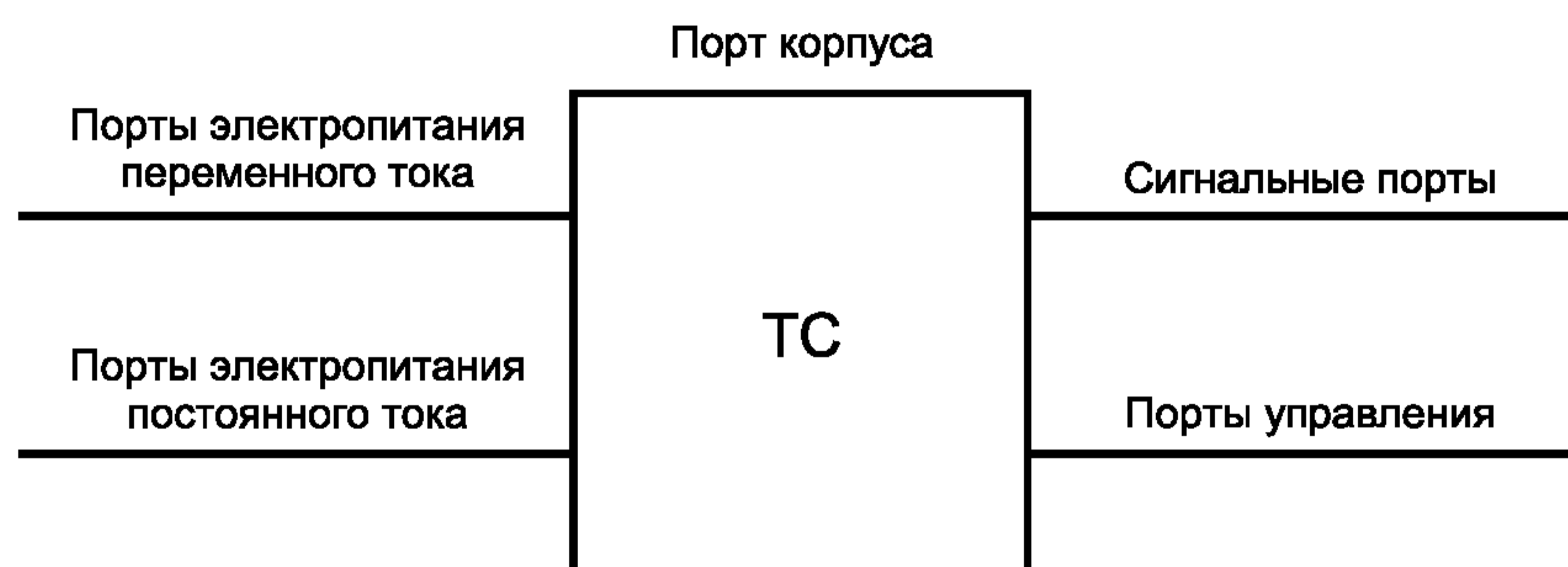
Рисунок 1 — Примеры портов ТС
