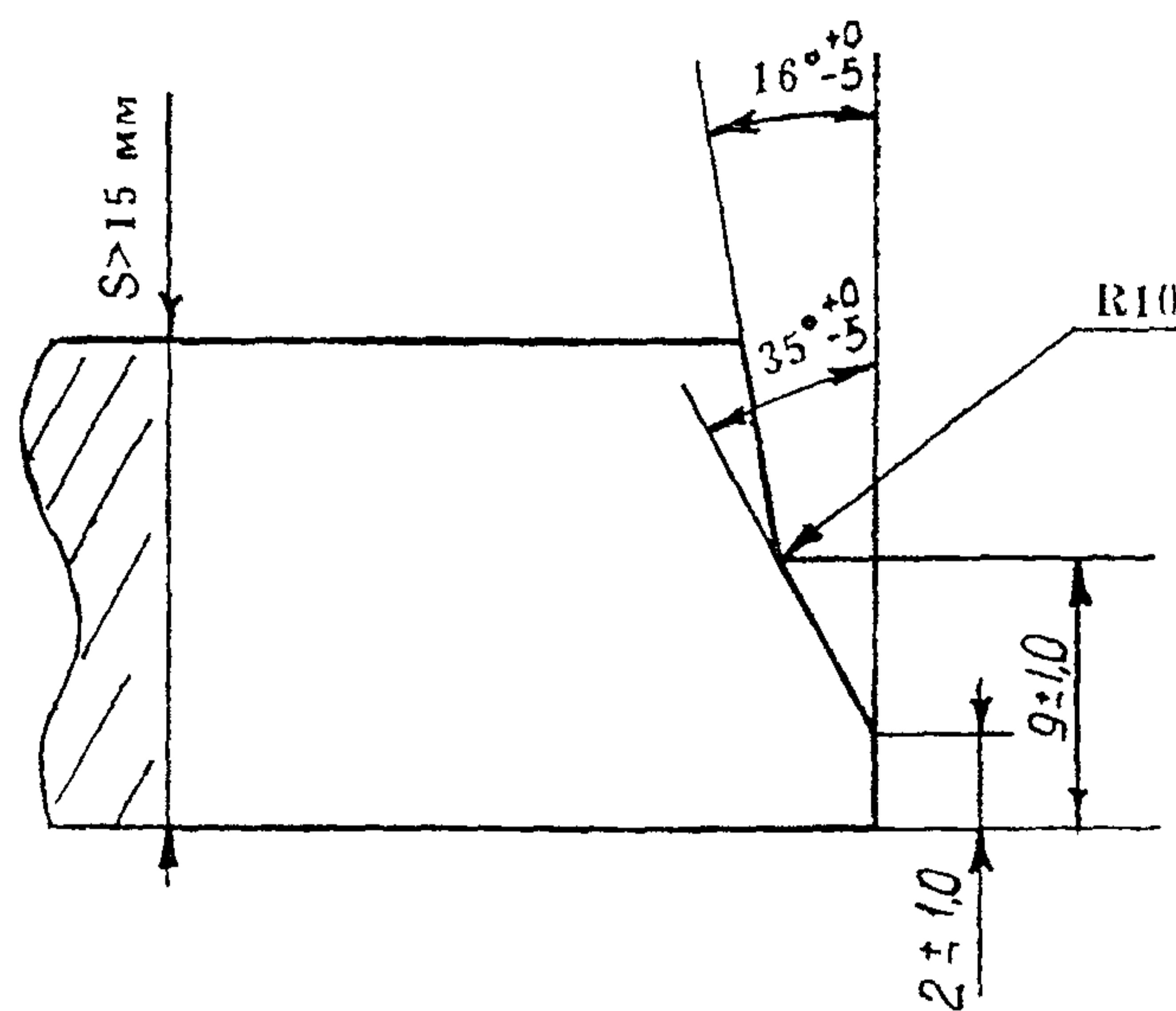
Рис. 1 Разделка кромок торцов трубы.
