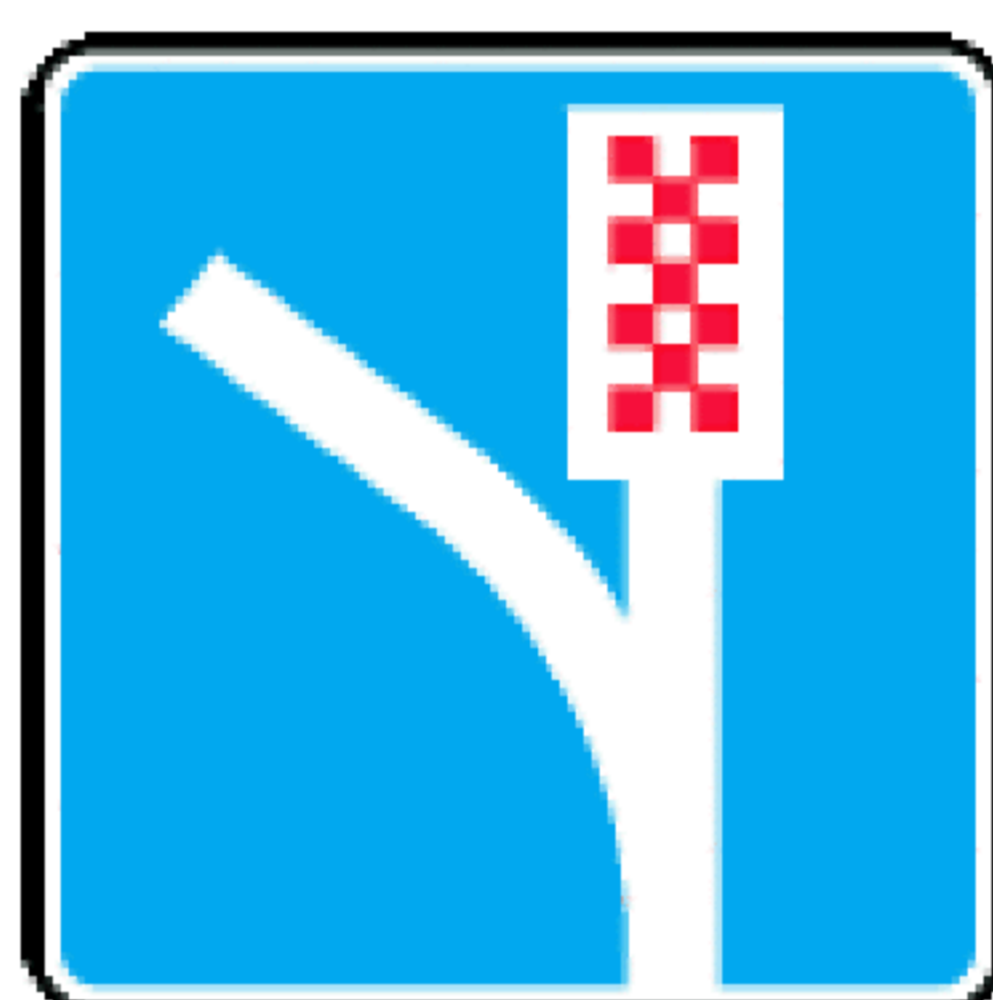
6.5 Полоса для аварийной остановки
