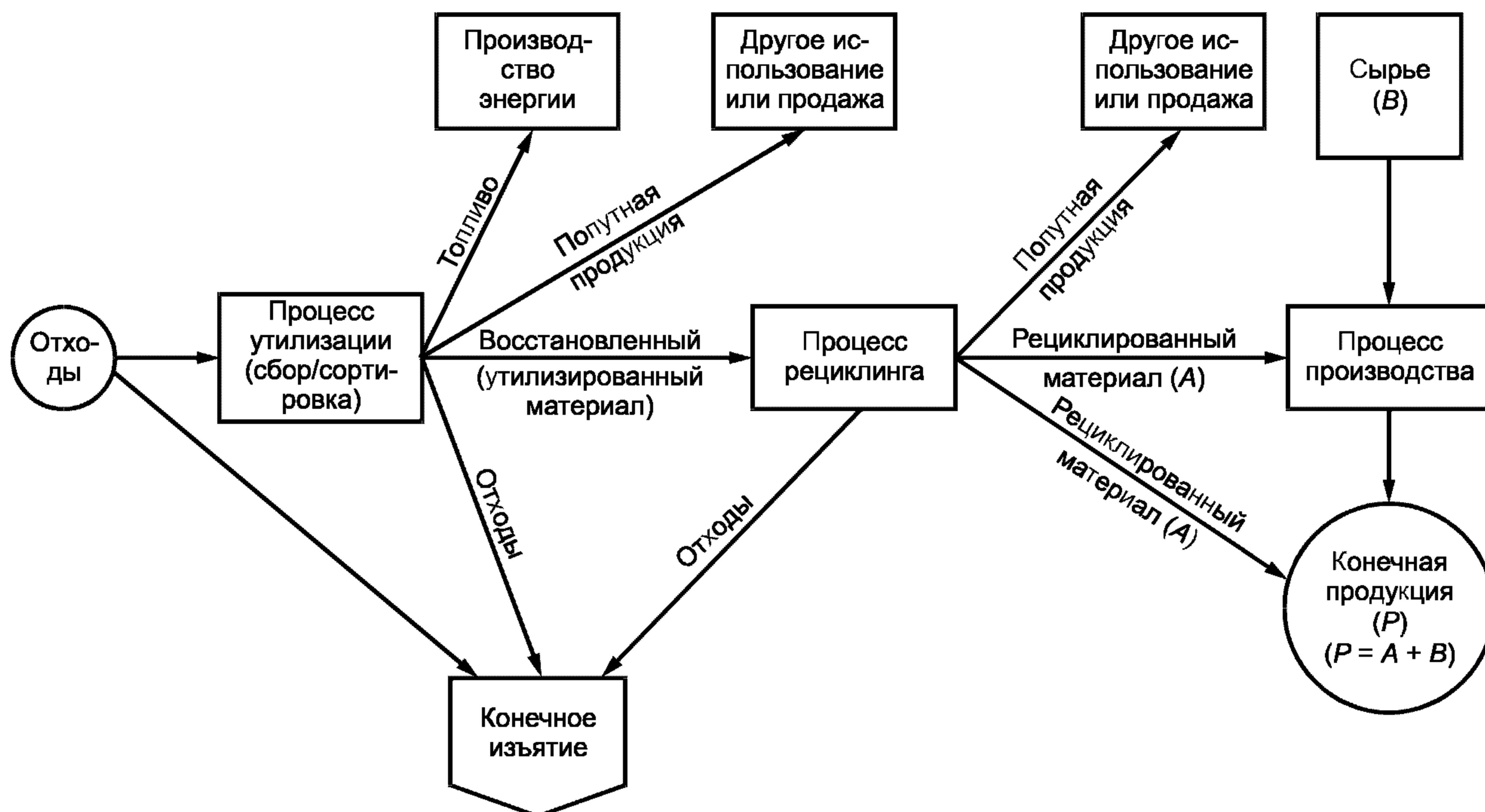
Рисунок А.1 — Упрощенная схема представления системы рециклинга
