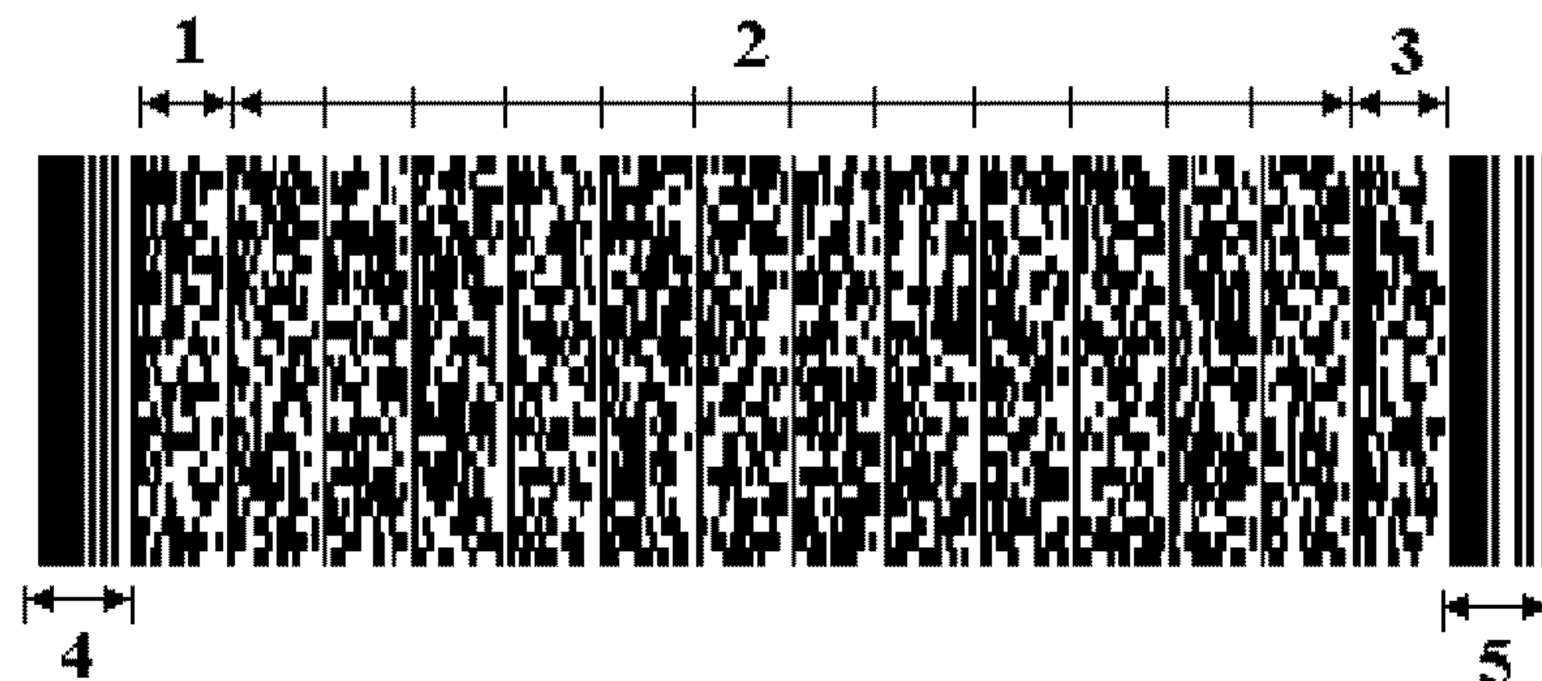
1 — столбец левого индикатора строк (Left row indicator); 2 — столбцы данных; 3 — столбец правого индикатора строк (Right row indicator); 4 — знак Start (СТАРТ); 5 — знак Stop (СТОП)
