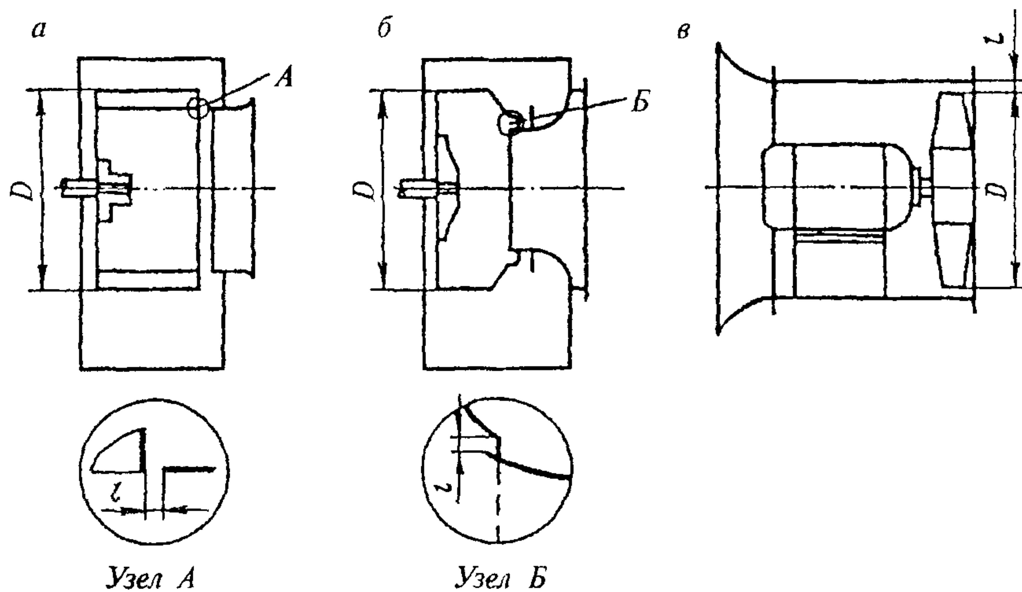
Рис. 2. Схемы зазоров вентиляторов:
