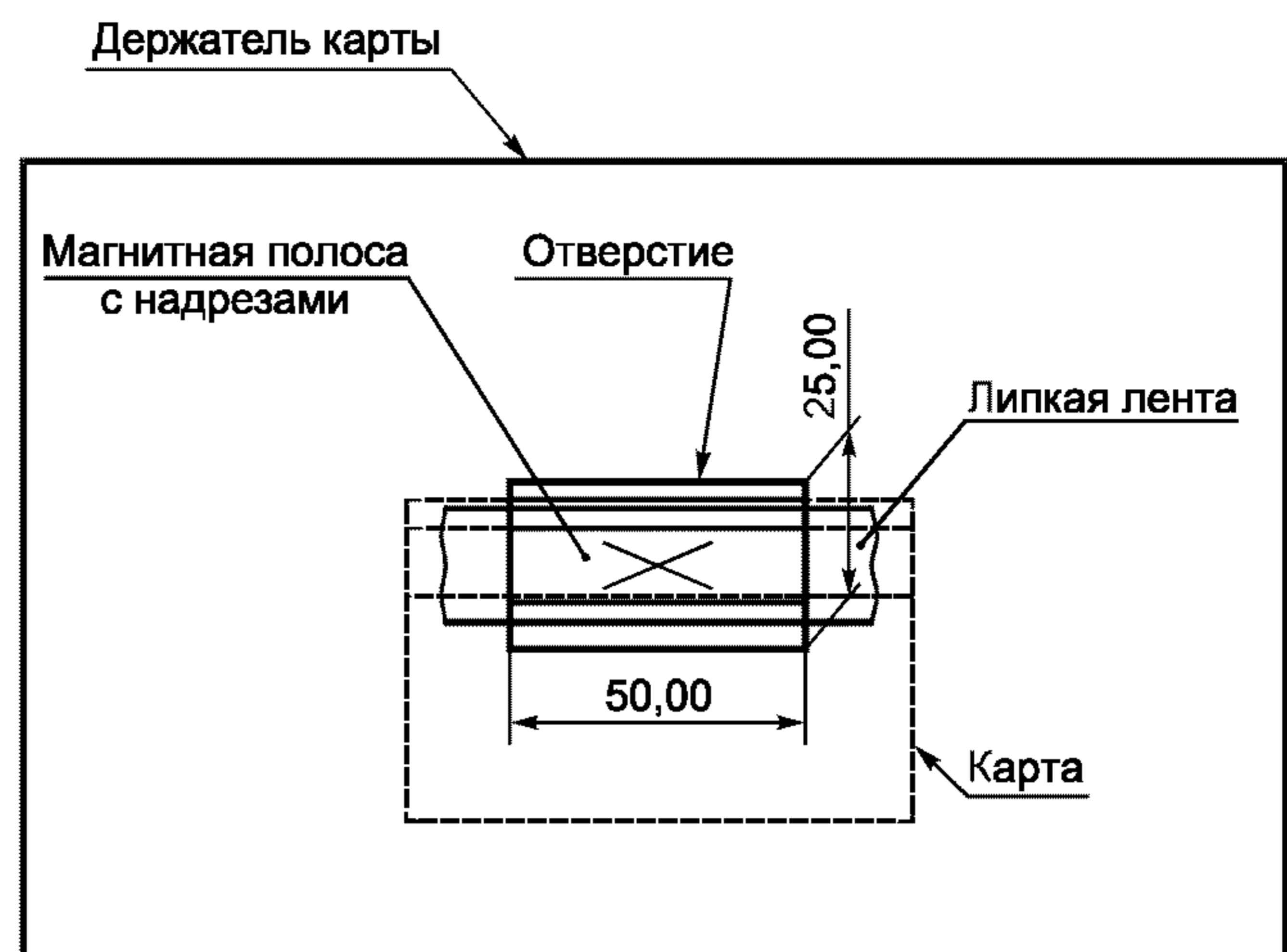
Рисунок 18 — Схема испытания магнитной полосы на адгезию
