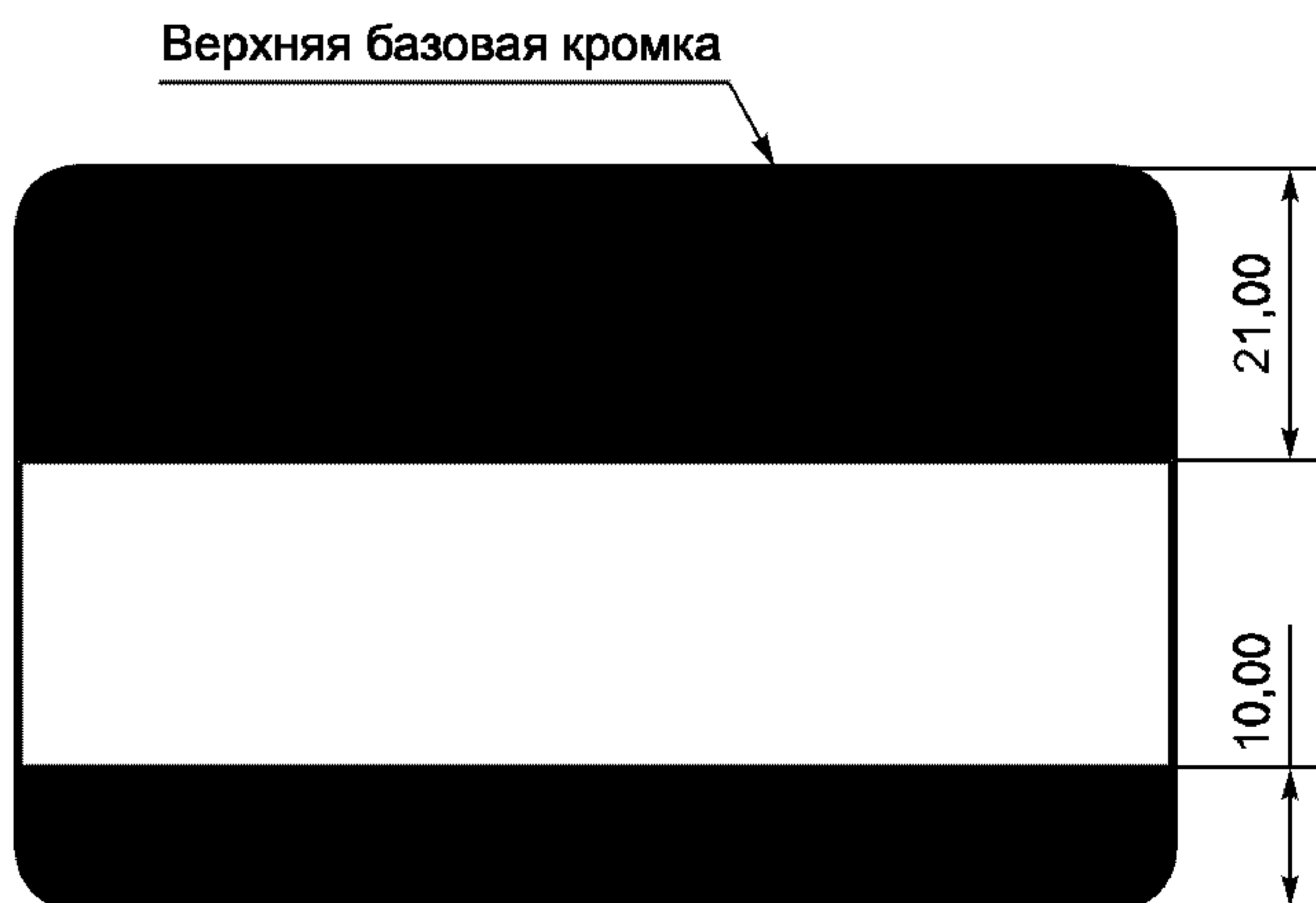
Рисунок 15 — Зоны измерения непрозрачности
