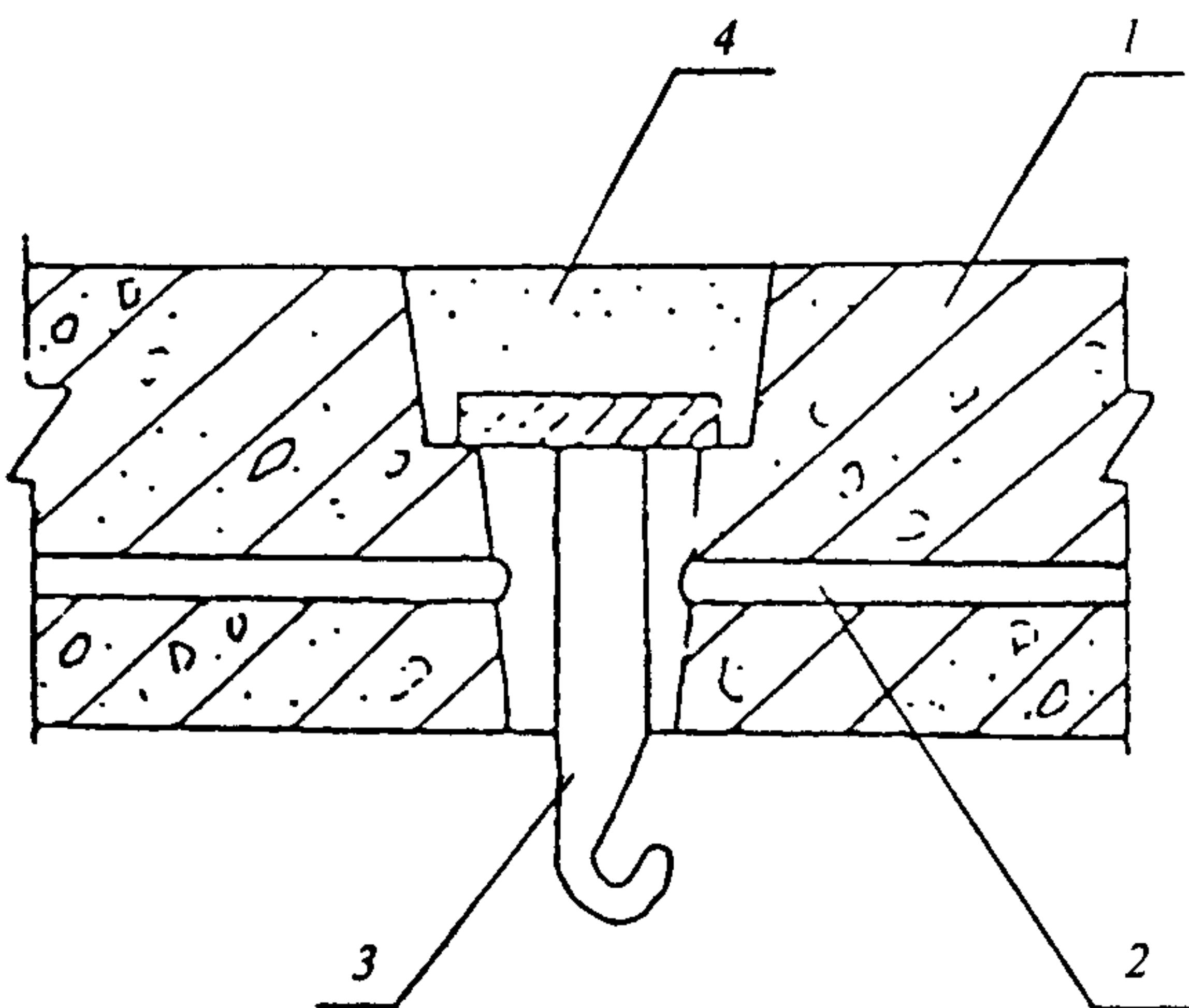
1 — панель перекрытия; 2 — электроканал; 3 — крюк (прикреплен к круглой стальной пластине); 4 — раствор (заделка нижней части отверстия условно не показана)
