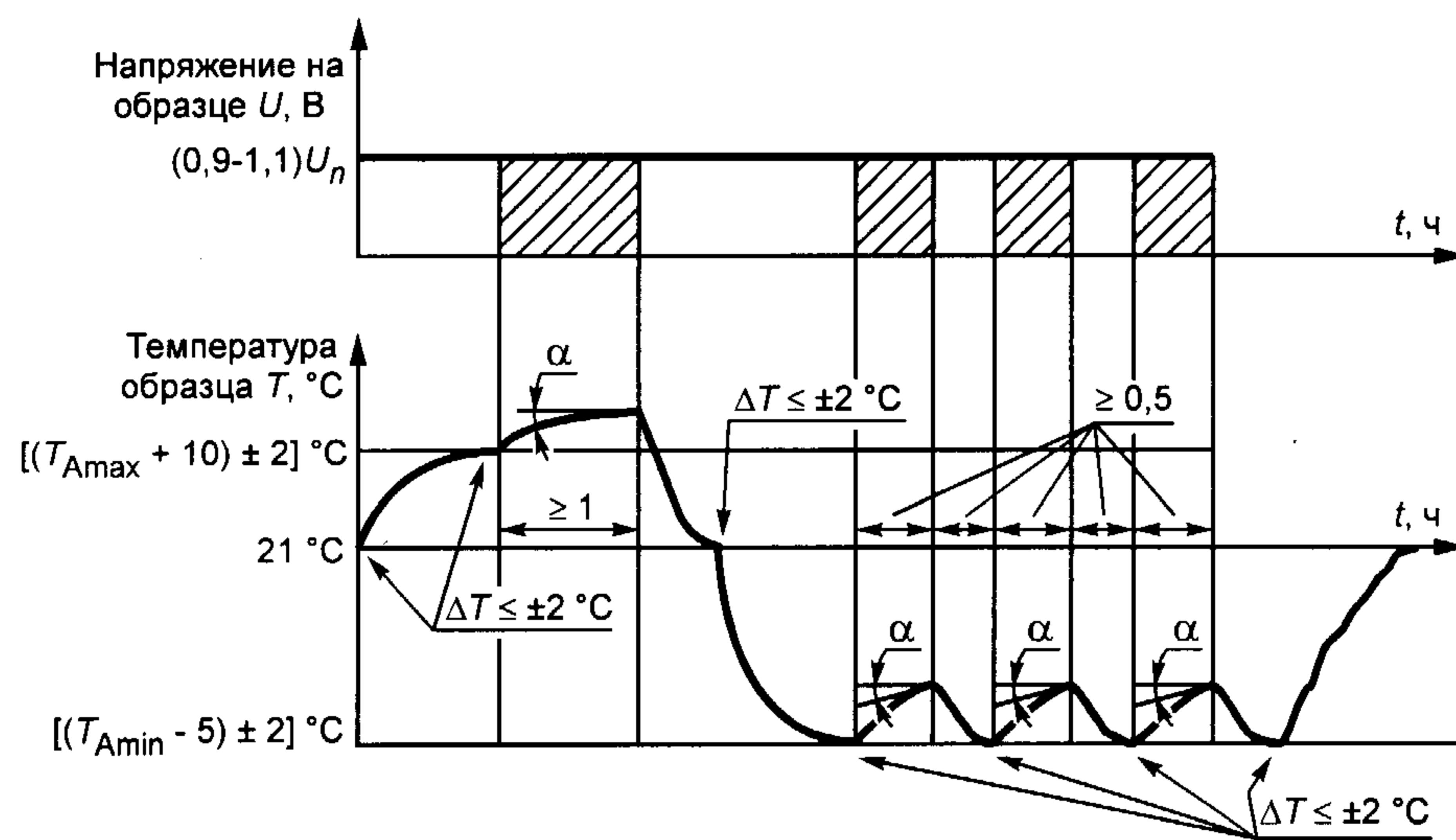
$T_{A\max}$  — заданная максимальная температура окружающей среды в эксплуатации;  $T_{A\min}$  — заданная минимальная температура окружающей среды в эксплуатации;  $U_n$  — номинальное напряжение;  $\operatorname{tg}\alpha$  — градиент температуры;  $\Delta T$  — разность температур внутренней и внешней частей образца
