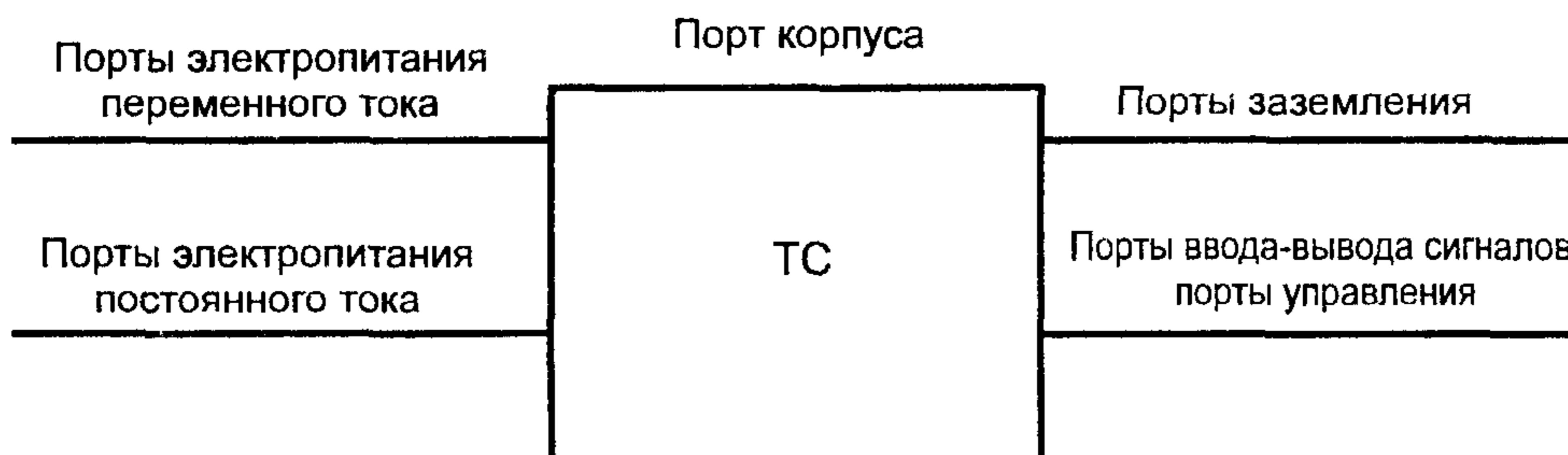
Рисунок 1 — Примеры портов ТС
