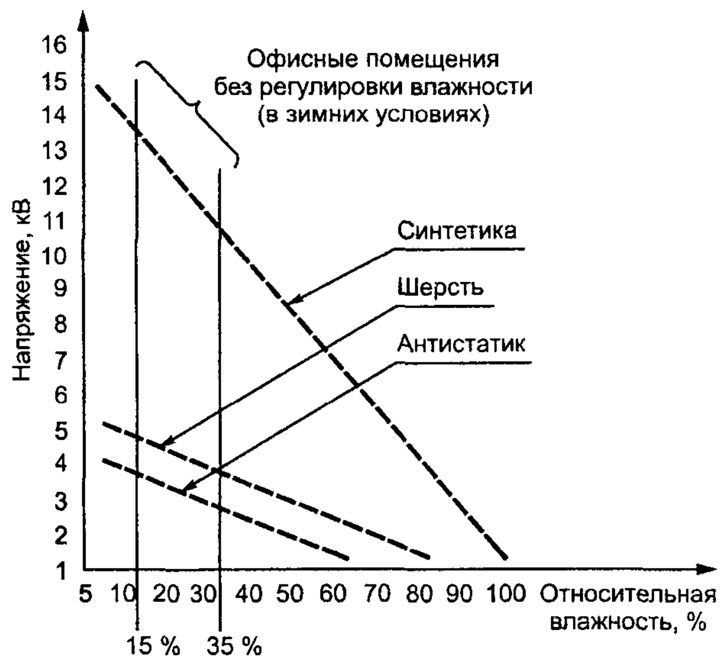
Рисунок А.1 — Максимальные значения напряжения, до которого могут быть заряжены операторы при контакте с материалами, упомянутыми в разделе А.2
