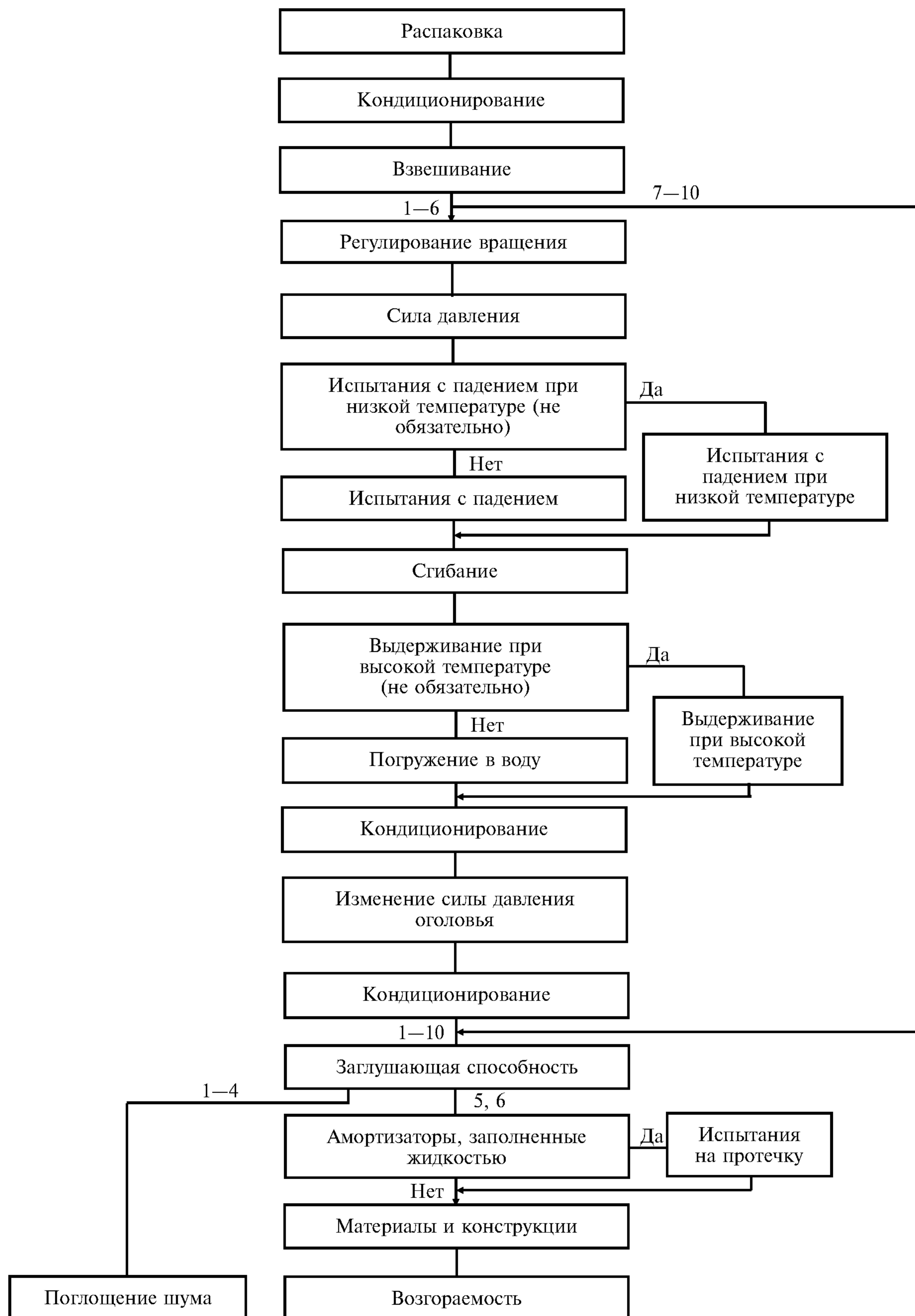
Рисунок 2 — Схема последовательности испытаний
