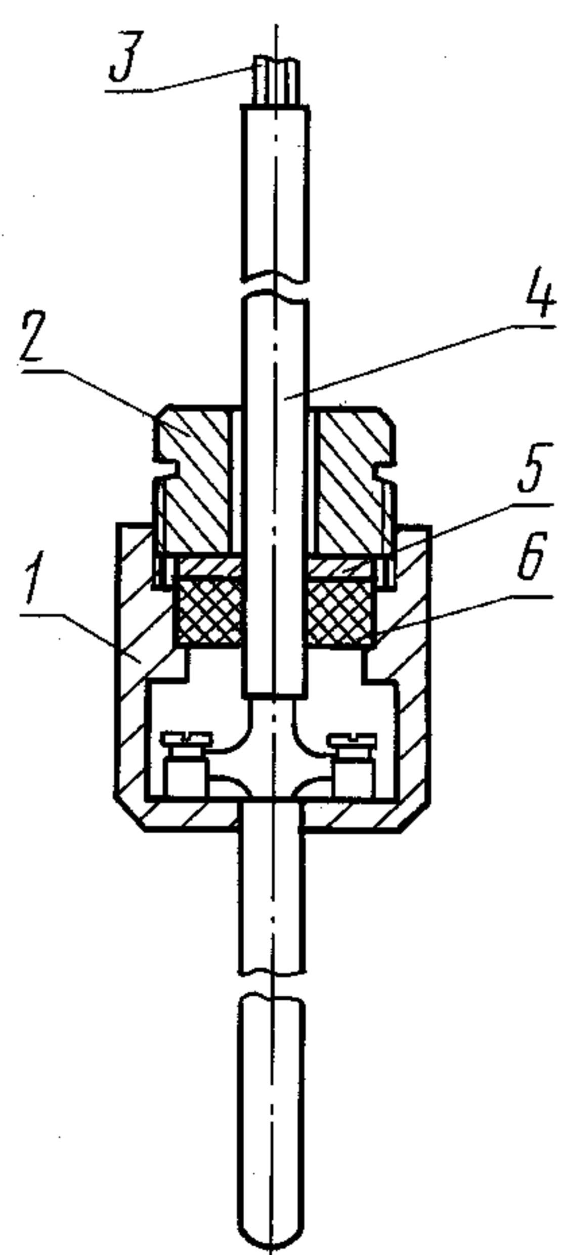
1 — контактная головка термопреобразователя; 2 — штуцер; 3 — провода;
