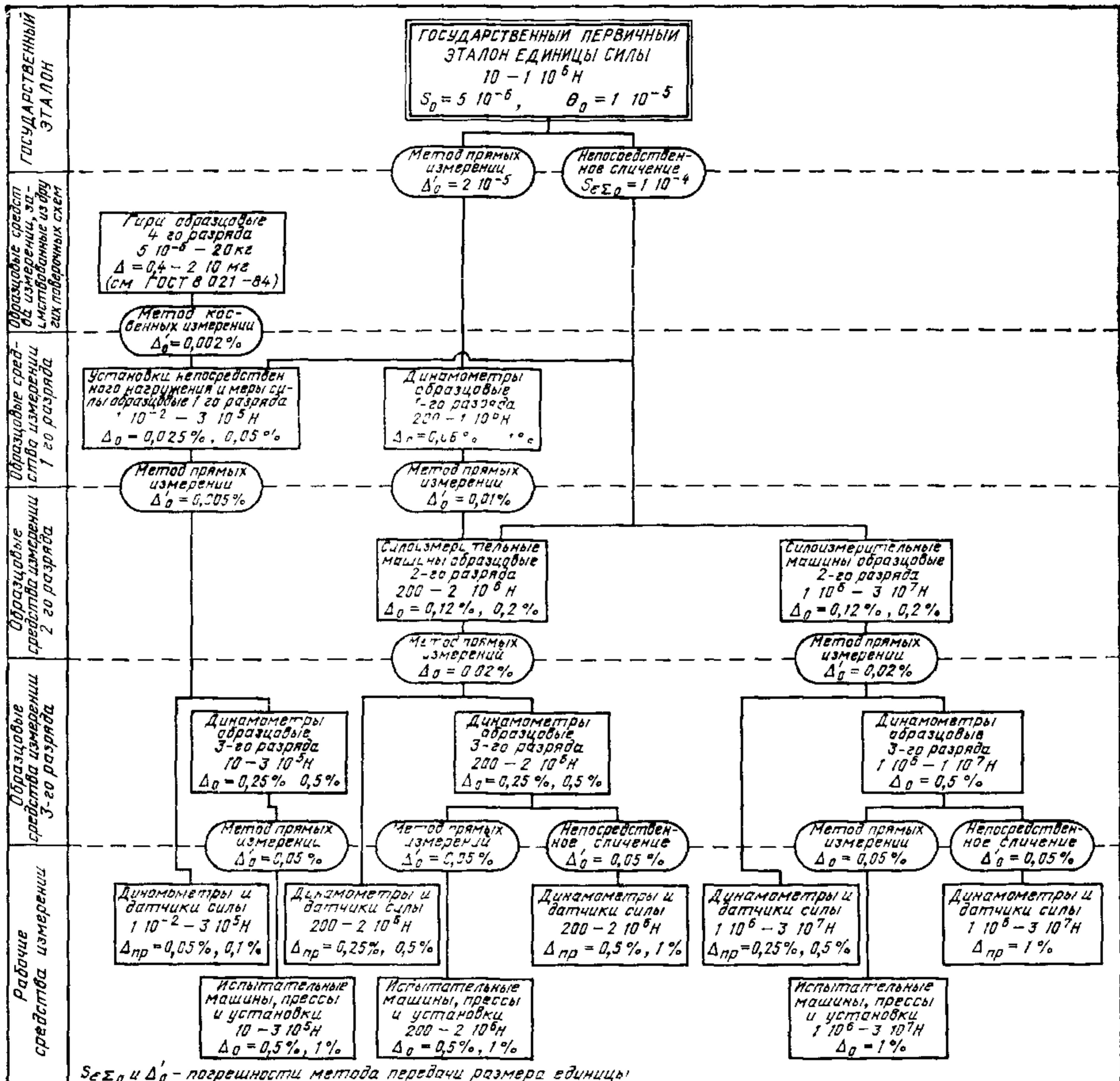
2.3.2. Пределы допускаемых относительных погрешностей  $\Delta_o$  образцовых средств измерений 2-го разряда составляют 0,12 и 0,2%.
