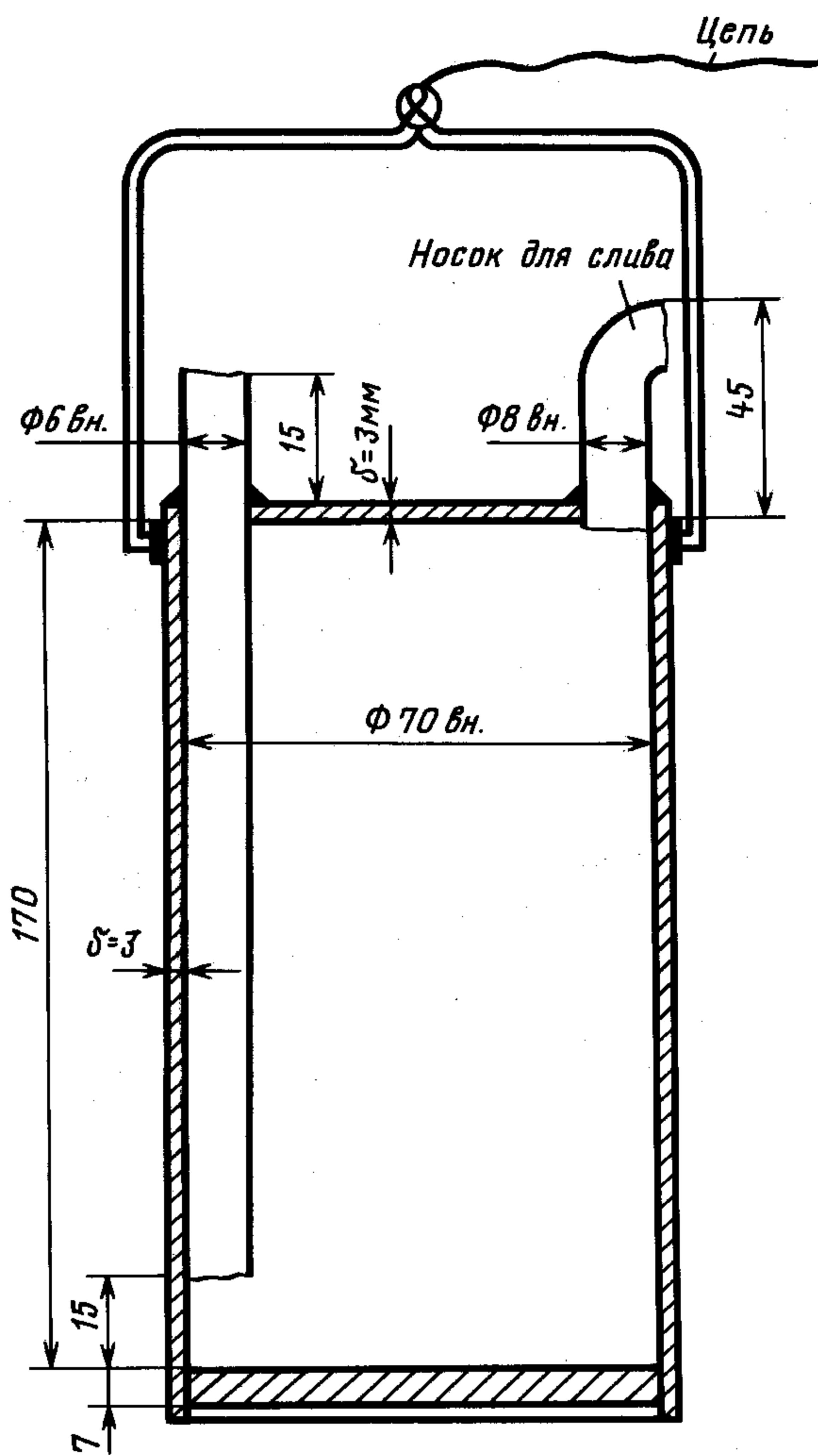
Крышку, трубы и дно скреплять сваркой
