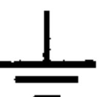
Зажим защитного заземления (при наличии) должен иметь электрически проводящее соединение с доступными для прикасания металлическими частями, не находящимися под напряжением;
