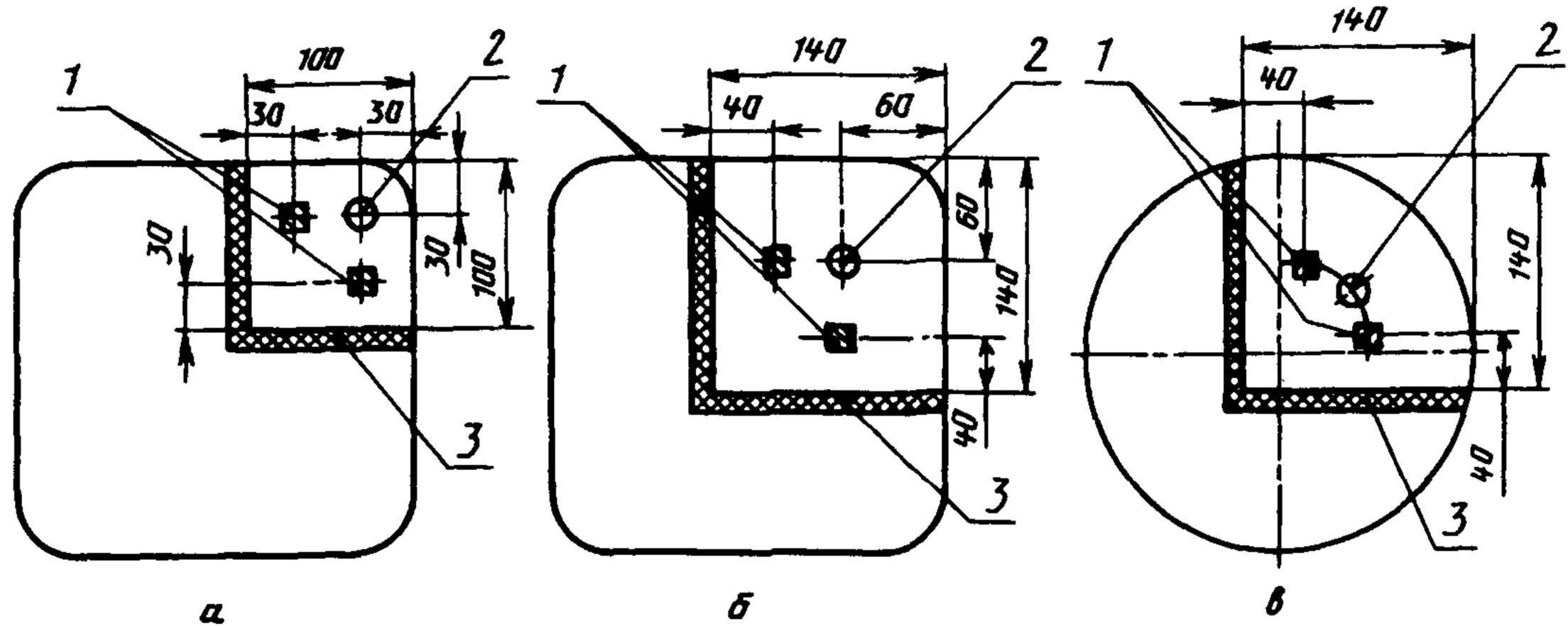
*а* — квадратная заготовка со стороной квадрата до 230 мм включительно; *б* — квадратная заготовка со стороной квадрата свыше 230 мм; *в* — круглая заготовка; 1 — два бруска для четырех образцов для испытания на ударную вязкость; 2 — образец для испытания на растяжение; 3 — автогенный рез
