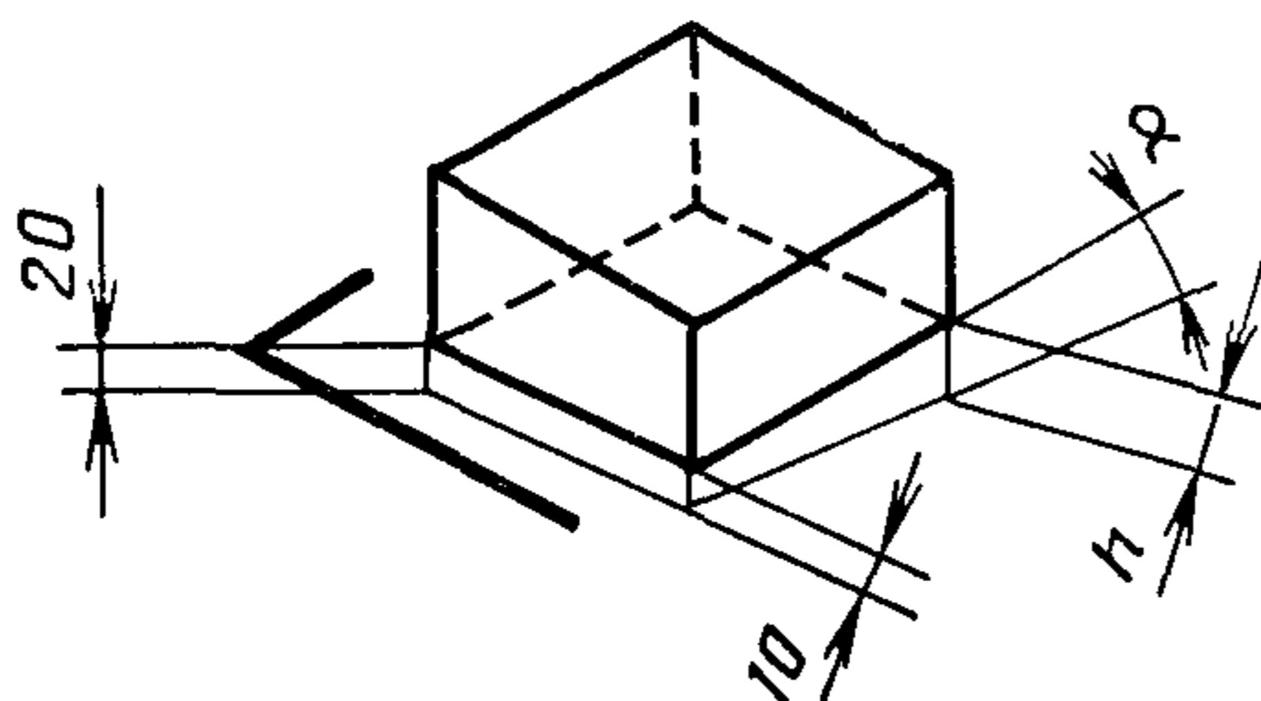
$h$  — расстояние между ребром образца и испытательной поверхностью;
