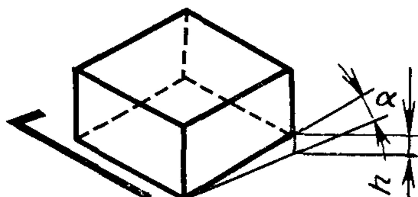
$h$  — расстояние между ребром образца и испытательной поверхностью;
