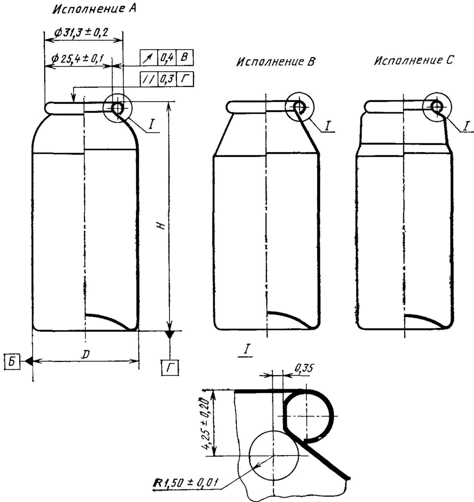
Примечание. Размеры  $R(1,50 \pm 0,01)$  и  $0,35$  не являются контролируемые и даны для изготовления инструмента.
