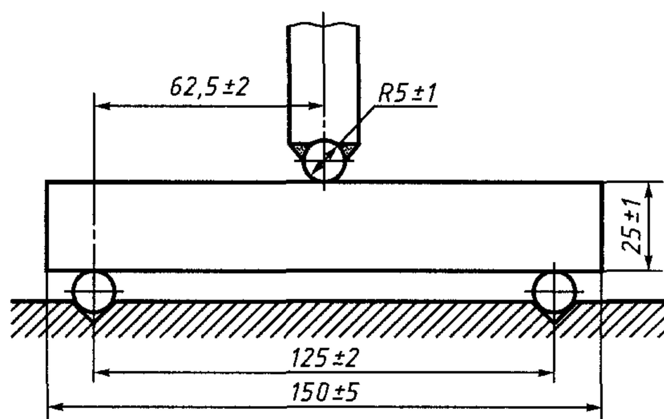
на обеспечивать равномерную нагрузку на середину образца по всей его ширине и возможность увеличения нагрузки с постоянной скоростью так, чтобы напряжение в образце увеличивалось со скоростью  $(0,15 \pm 0,015)$  Н/мм<sup>2</sup> · с<sup>-1</sup>. Погрешность измерения изгибающей силы в момент разрушения образца должна быть не более ± 2 %.
