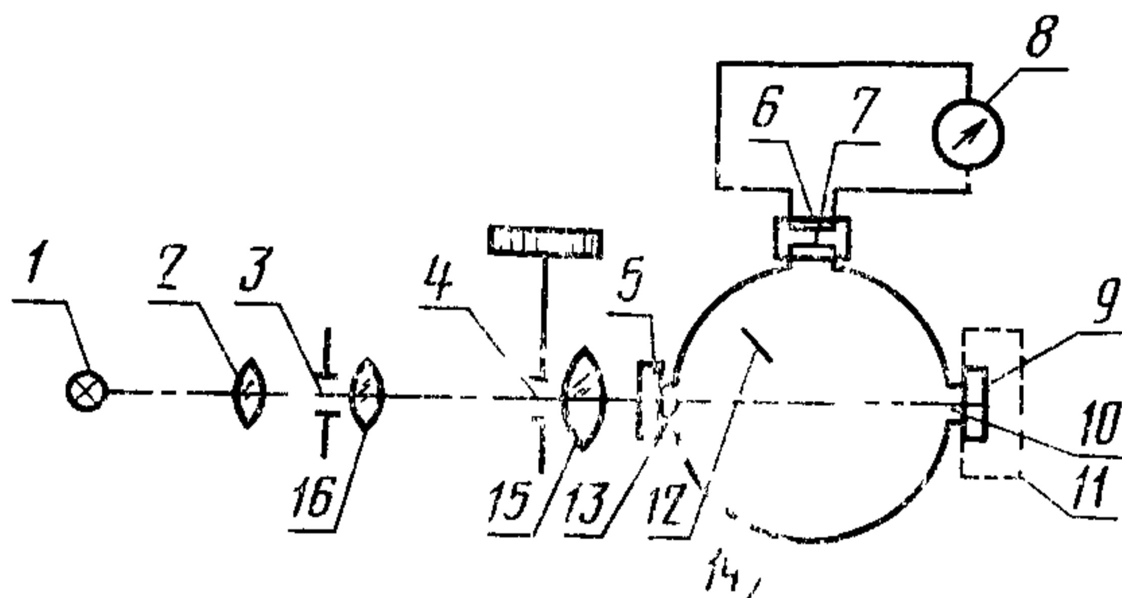
1—источник света 2—конденсор, 3 4—диафрагмы, 5—об разец, 6—фотоэлемент, 7—молочное стекло 8—измерительный прибор 9—белая пластина 10—выходное отверстие 11—световая ловушка 12—экран, 13—входное отверстие 14—фотометрический шар, 15, 16—линзы
