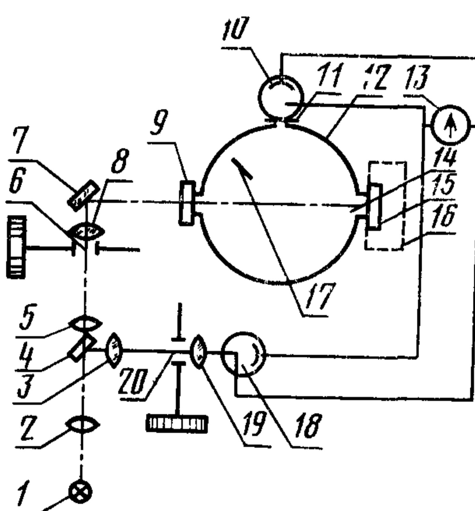
1—источник света, 2—конденсор, 3, 5, 8, 19—линзы, 4—светоделительная пластина, 6—измерительная диафрагма, 7—поворотное зеркало, 9—образец, 10, 18—фотоэлементы, 11—молочное стекло, 12—фотометрический шар, 13—нуль-гальванометр, 14—выходное отверстие, 15—белая пластина, 16—световая ловушка, 17—экран, 20—компенсационная диафрагма
