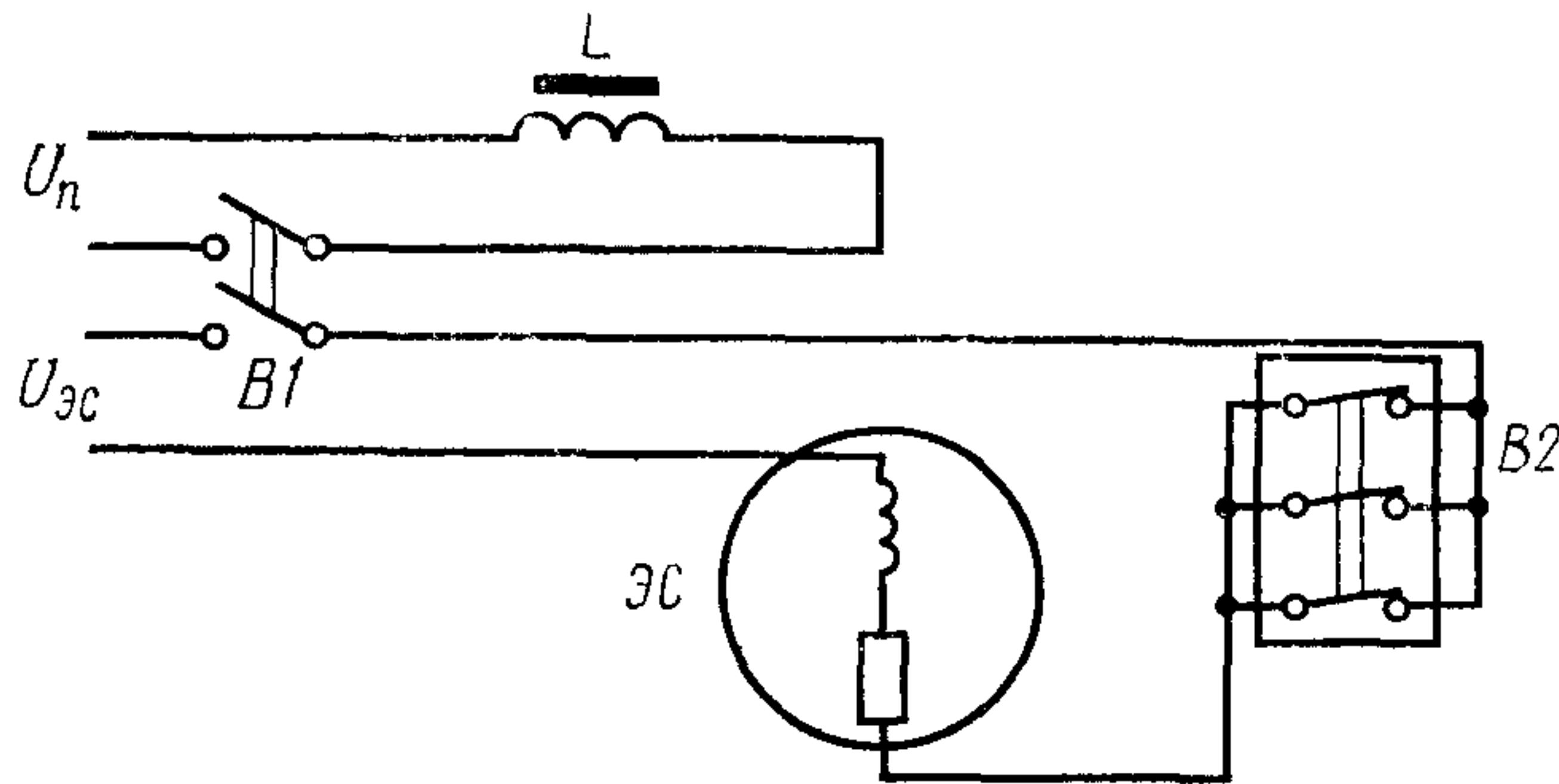
$L$  — отключающая катушка привода;  $U_n$  — напряжение на зажимах привода;  $U_{\text{ЭС}}$  — напряжение электросекундомера;  $B1$  — тумблер;  $B2$  — испытуемый коммутационный аппарат
