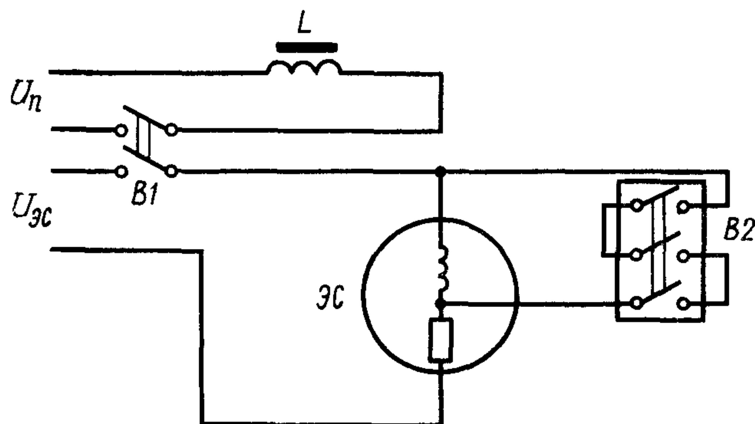
$L$  — катушка контактора — для электромагнитного привода (включающая катушка — для других типов привода);  $\text{ЭС}$  — электросекундомер;  $B1$  — тумблер;  $B2$  — испытуемый коммутационный аппарат.
