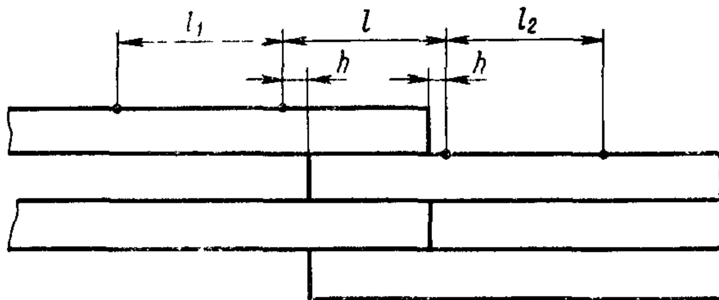
$l$  — условная длина контактного соединения;  $l_1$ ,  $l_2$  — цепные участки шин;  $l=l_1=l_2$ ;  $h=5$  мм
