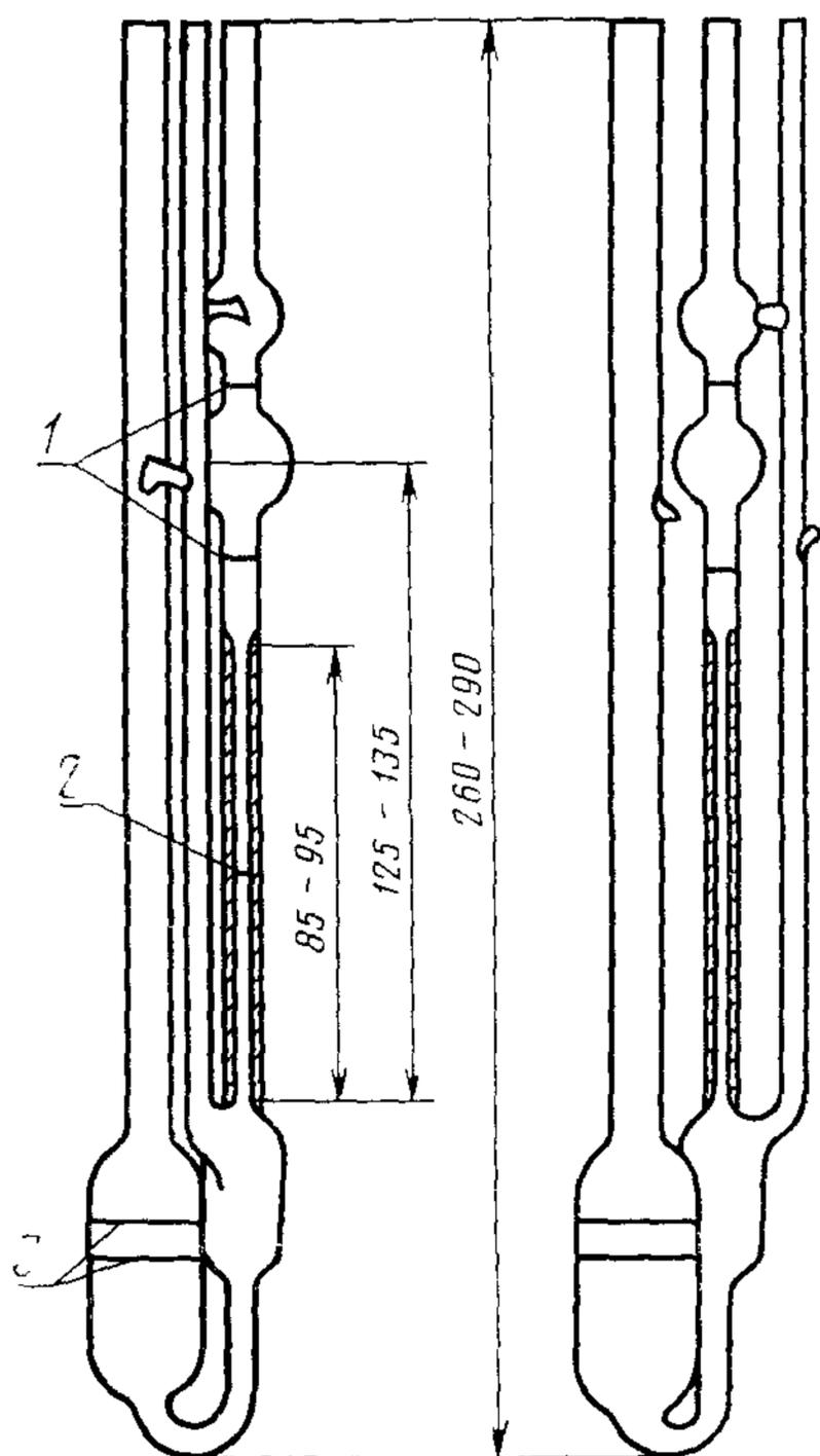
1 — метки, соответствующие вместимости от 4 до 6 мм, 2—капилляр диаметром от 0,55 до 0,65 мм, 3 — метки наполнения
