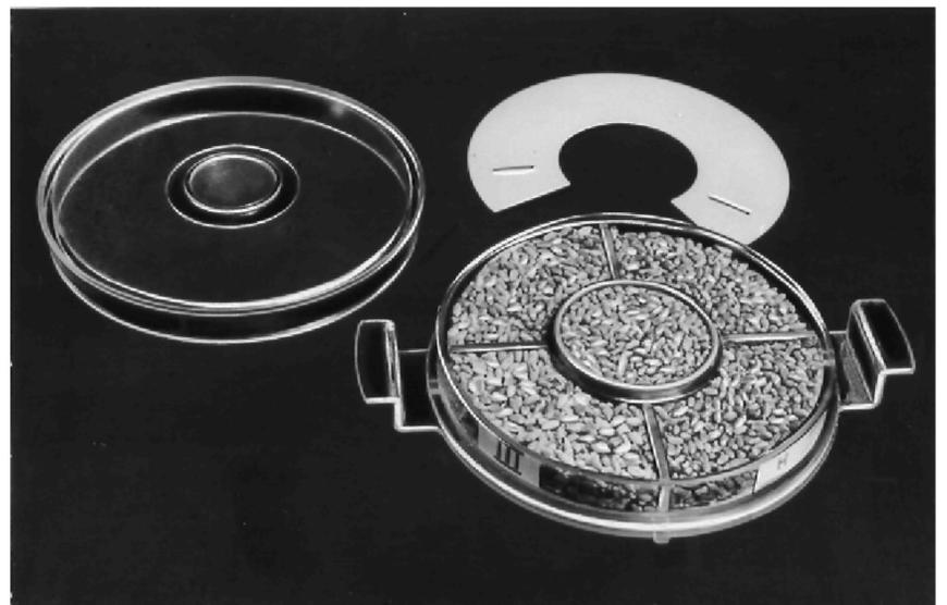
При сравнении зерна пробы с одним из эталонов три других эталона закрывают металлическим экраном.
