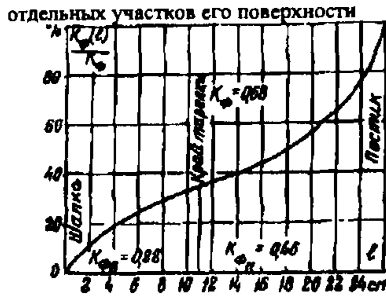
Рис.18. График для определения коэффициента формы изолятора ПС6-А [ПС-4,5] (чертеж И-319) и коэффициентов формы отдельных участков его поверхности
