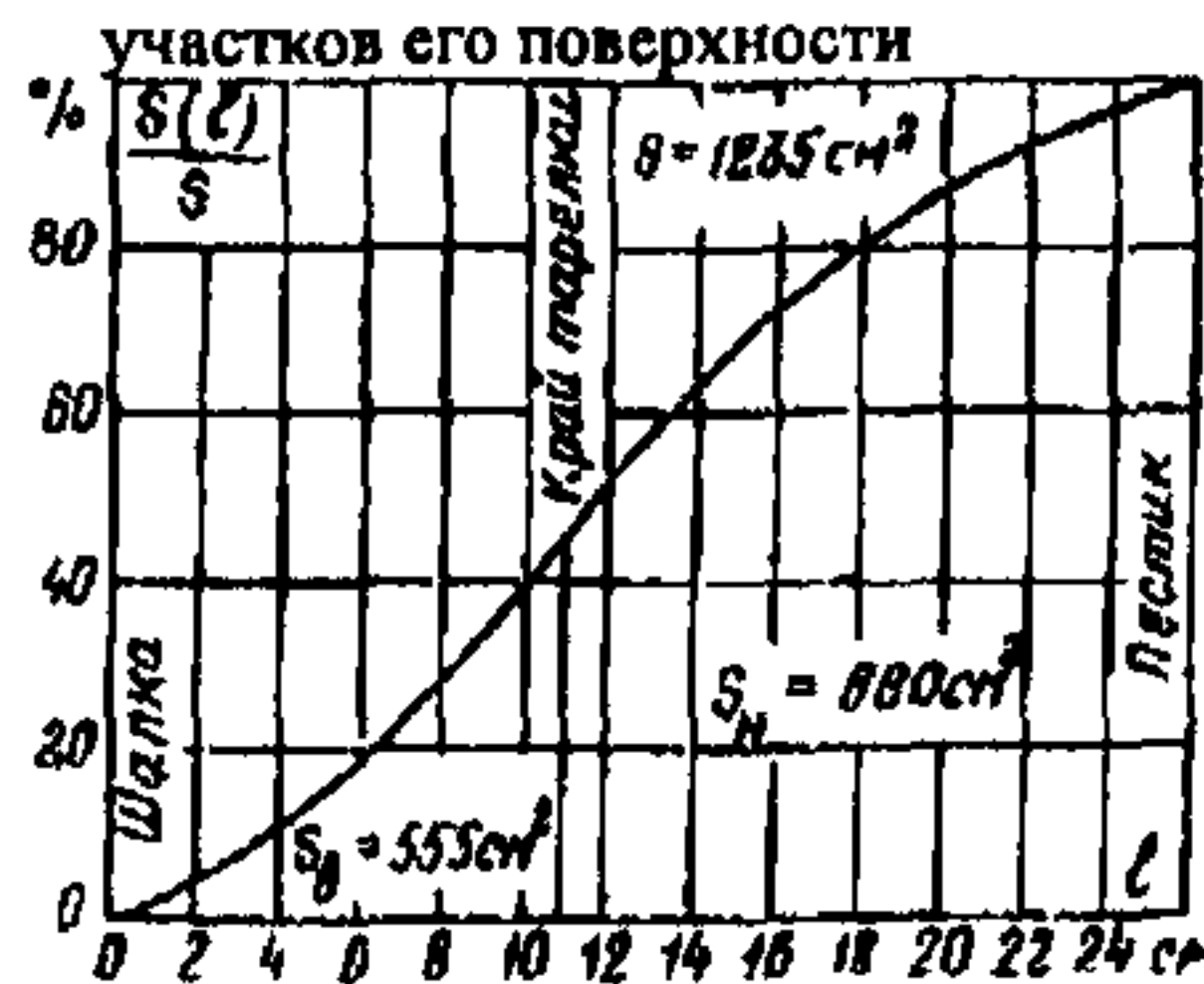
Рис.35. График для определения площади поверхности изоляторов ПС6-А [ПС-4,5] (чертеж И-319) и площадей отдельных участков его поверхности
