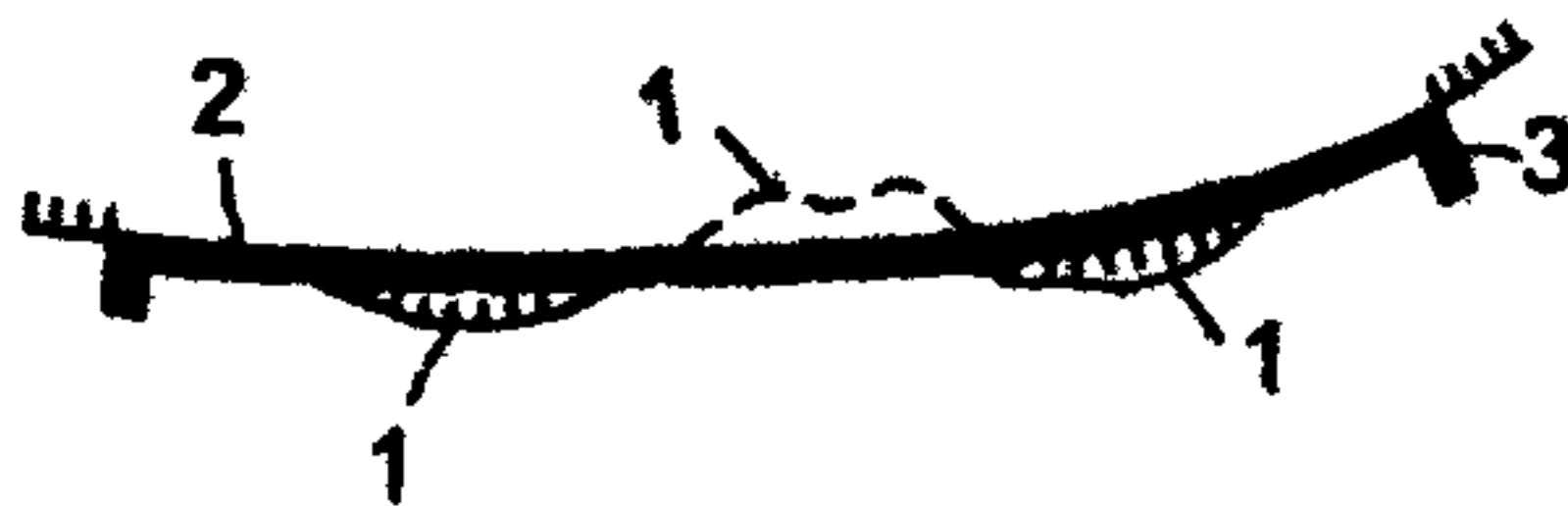
Рис. 4.17. Схема участка расположения вдольберегового укрепления: 1 - линия размыва, 2 - проектное положение укрепляемого берега, 3 - концевые участки укрепления.
