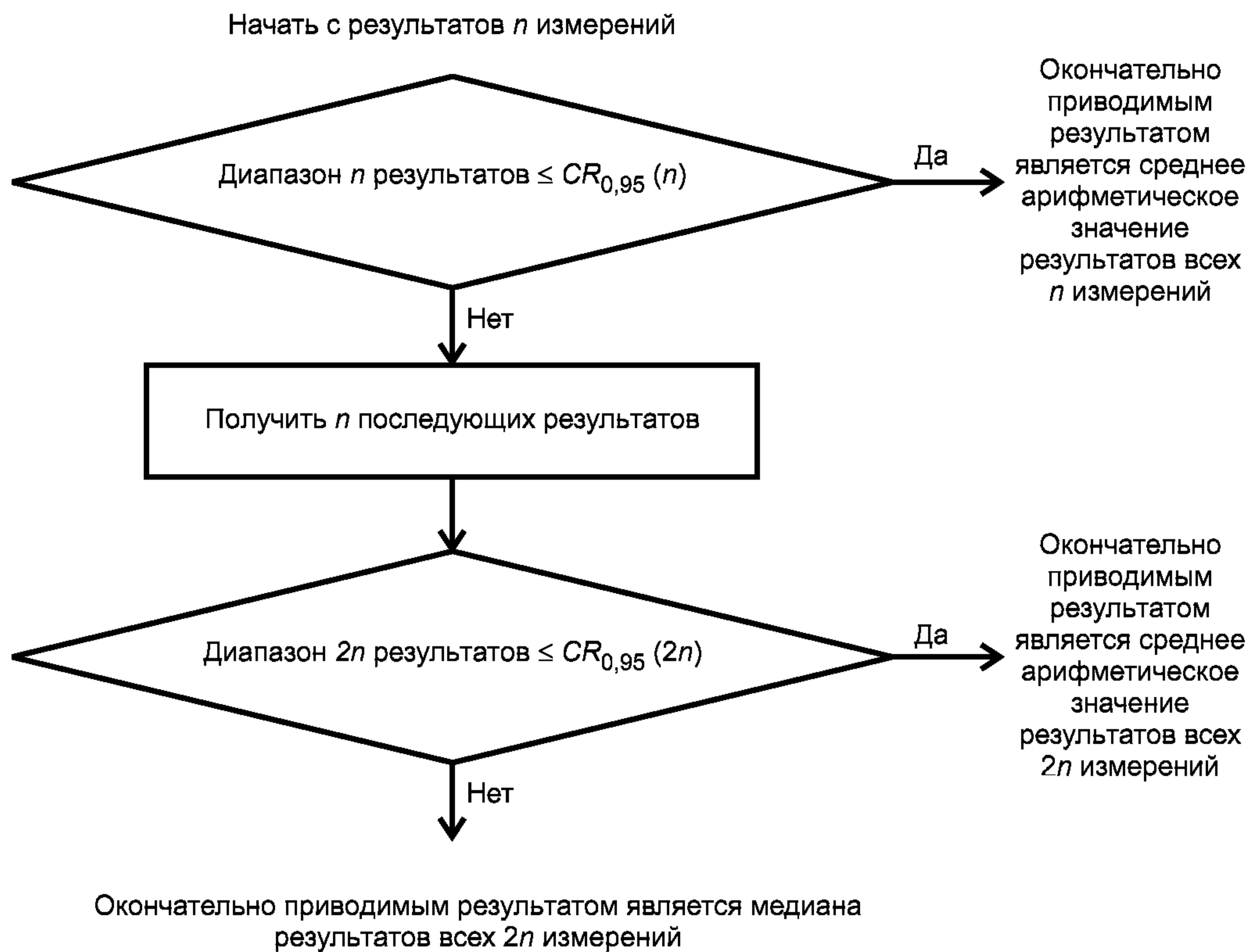
Рисунок 4 — Метод проверки приемлемости результатов измерений, полученных в условиях повторяемости, при первоначальном получении n результатов измерений и условии, что получение результатов измерений не является дорогостоящим (вариант А)
