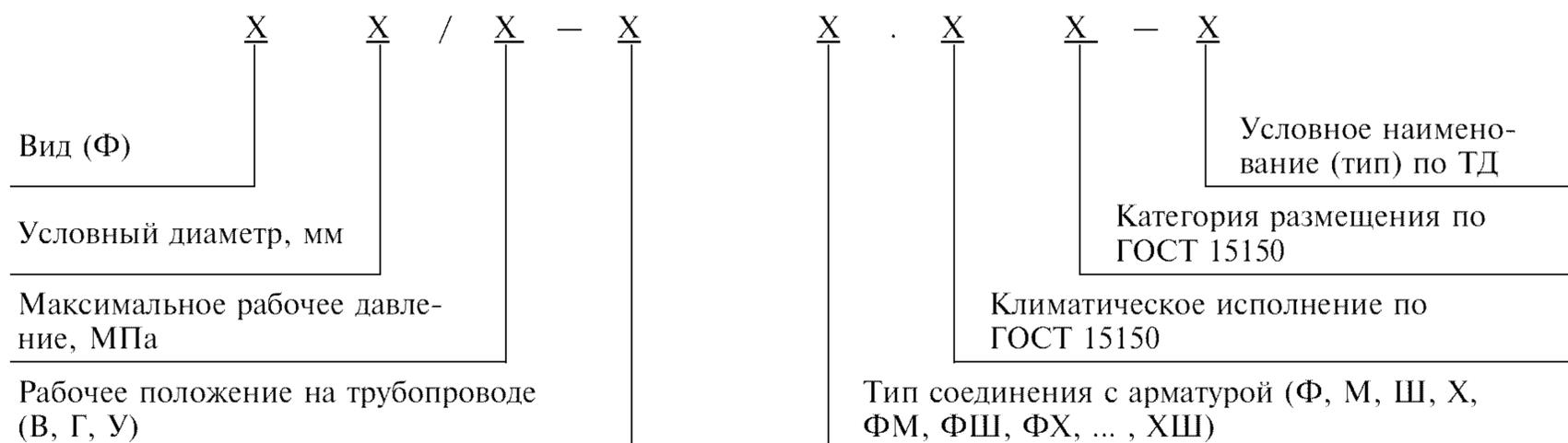
5.10.2 Пример условного обозначения фильтра с проходом условным диаметром 10 мм, максимальным рабочим давлением 1,2 МПа, вертикальным рабочим положением на трубо-
