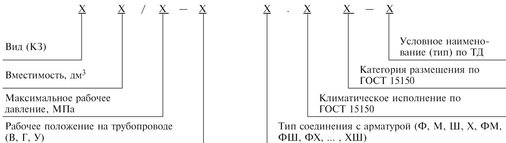
5.12.2 Пример условного обозначения камеры задержки вместимостью 5 дм<sup>3</sup>, с максимальным рабочим давлением 1,2 МПа, вертикальным рабочим положением на трубопроводе, штуцерным типом соединения, климатическим исполнением У, категорией размещения 4, условным наименованием «Камера ВМ»:
