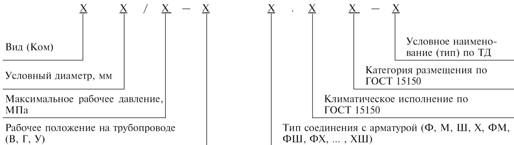
5.11.2 Пример условного обозначения компенсатора с проходом условным диаметром 10 мм, максимальным рабочим давлением 1,2 МПа, вертикальным рабочим положением на трубопроводе, муфтовым типом соединения с арматурой, климатическим исполнением У, категорией размещения 4, условным наименованием «Патрон»:
