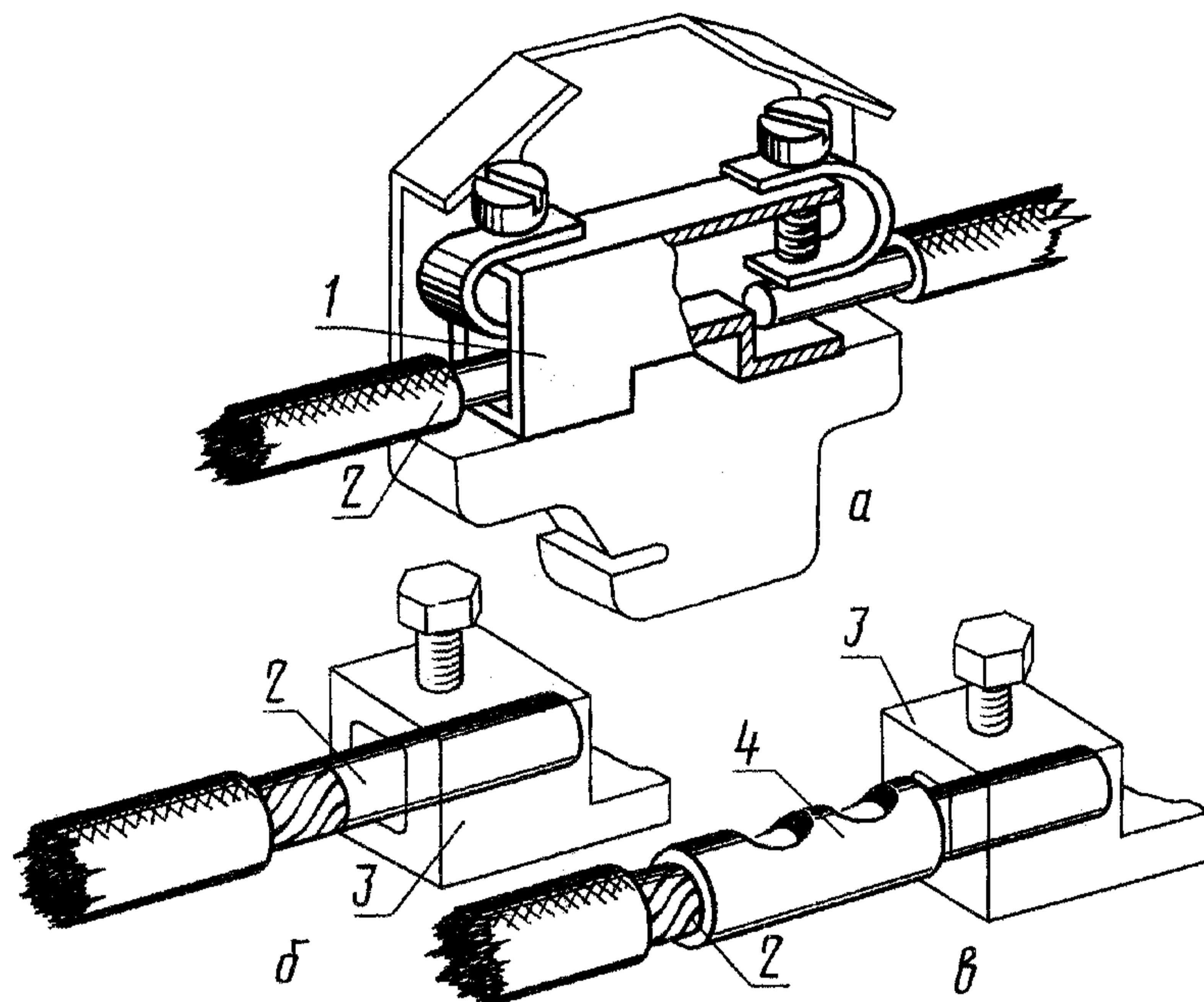
*a, б — однопроволочная (многопроволочная, сплавленная в монолит) жила; в — многопроволочная жила, оконцованныя кабельным наконечником*
