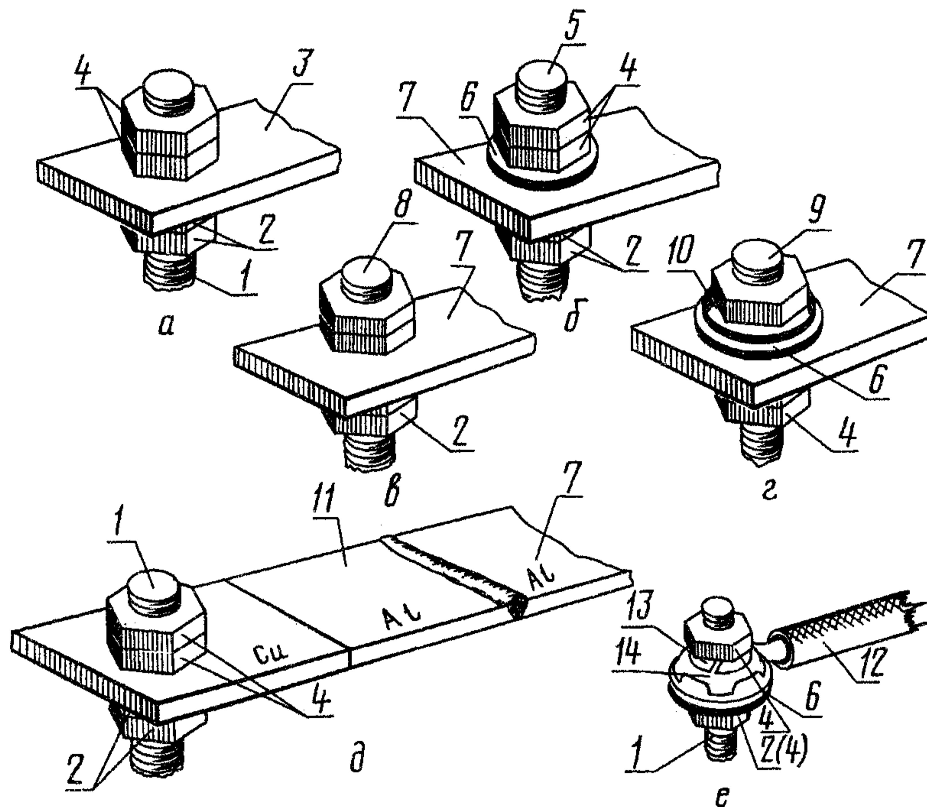
*a* — проводник из меди, твердого алюминиевого сплава или алюминия с защитным металлическим покрытием рабочей поверхности; *b*, *c*, *g* — алюминиевый проводник; *d* — алюминиевый проводник через переходную медно-алюминиевую пластину; *e* — однопроволочная (многопроволочная) жила провода кабеля сеч. 10 мм<sup>2</sup> с изгибанием в кольцо
