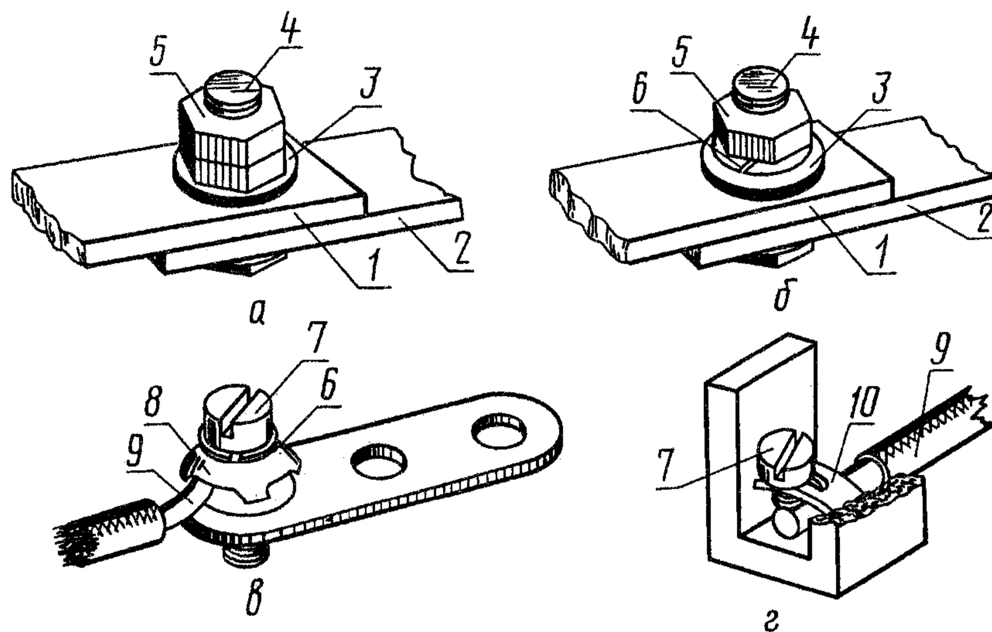
*a — с контргайкой; б — с пружинной шайбой; в — однопроволочная (многопроволочная) жила провода (кабеля) сеч. до 10 мм<sup>2</sup> с изгибанием в кольцо; г — однопроволочная (многопроволочная) жила провода (кабеля) сеч. до 10 мм<sup>2</sup> без изгиба в кольцо*
