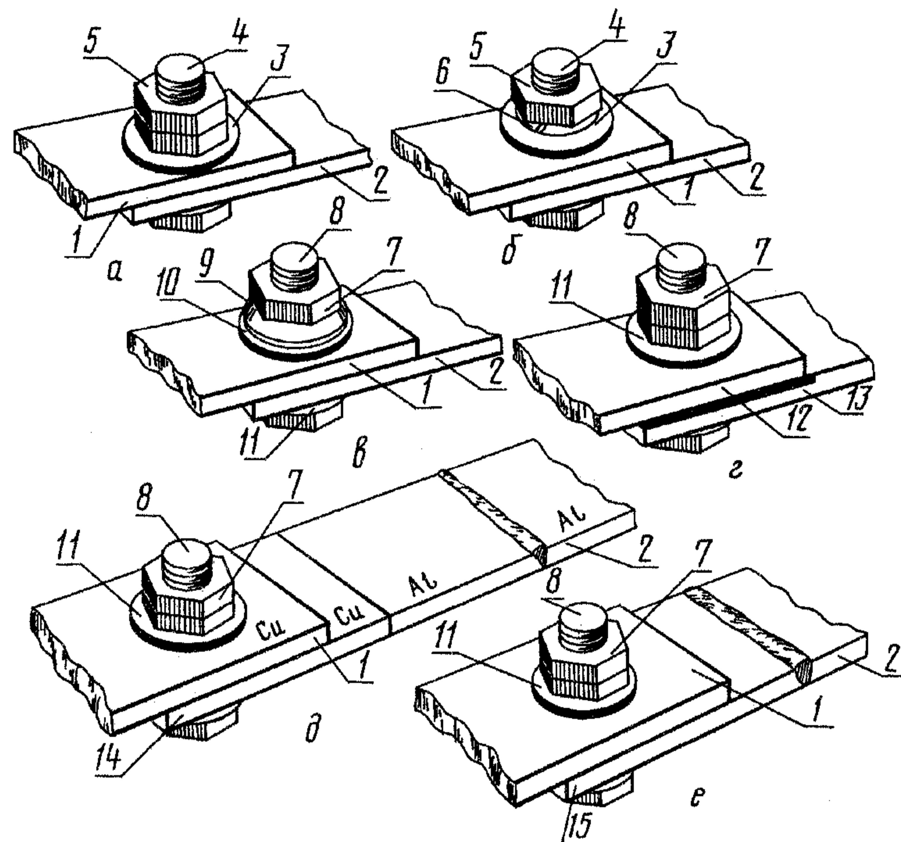
*a* — крепежом из цветного металла с контргайкой; *b* — крепежом из цветного металла с пружинной шайбой; *c* — стальным крепежом с тарельчатой пружиной; *d* — стальным крепежом с защитными металлическими покрытиями рабочих поверхностей с контргайкой (пружинной шайбой); *e* — стальным крепежом через переходную медно-алюминиевую пластину с контргайкой (пружинной шайбой)
