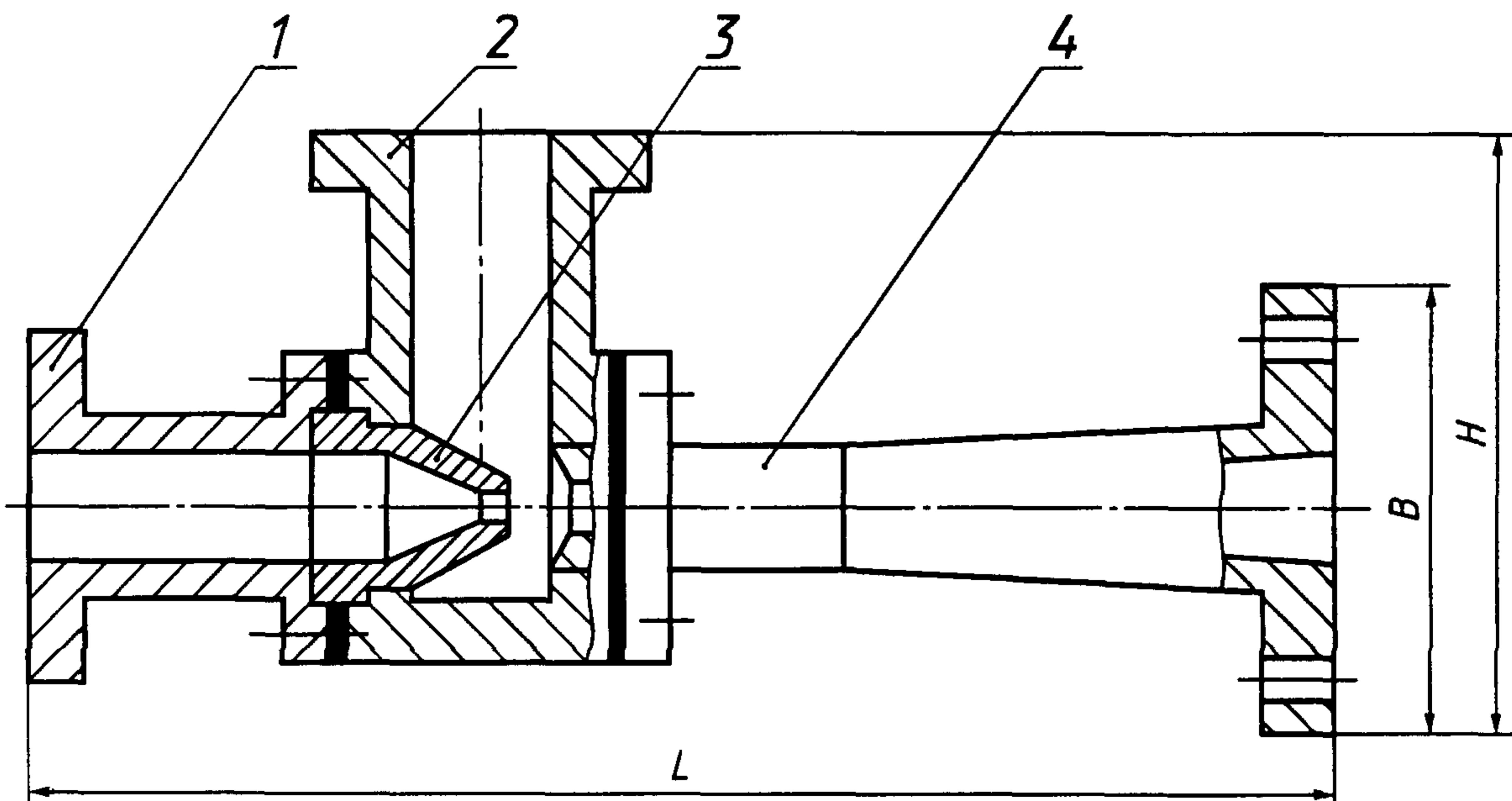
1 — входной патрубок; 2 — всасывающая камера; 3 — сопло; 4 — выходной патрубок
