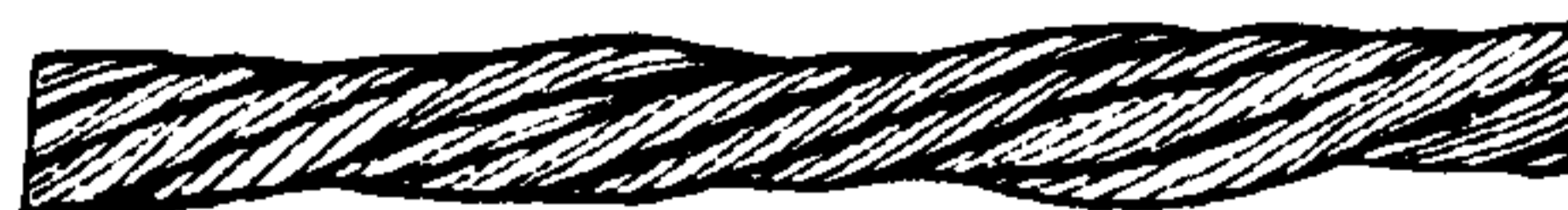
Рис. 7. Местное уменьшение диаметра каната на месте разрушения органического сердечника
