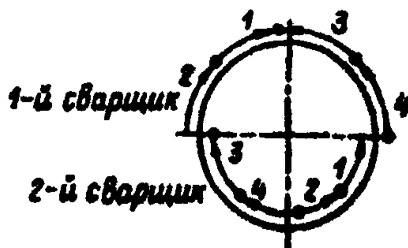
Рис. 5.17. Порядок наложения валиков при сварке первого слоя стыков труб диаметром 1200 мм и более:
