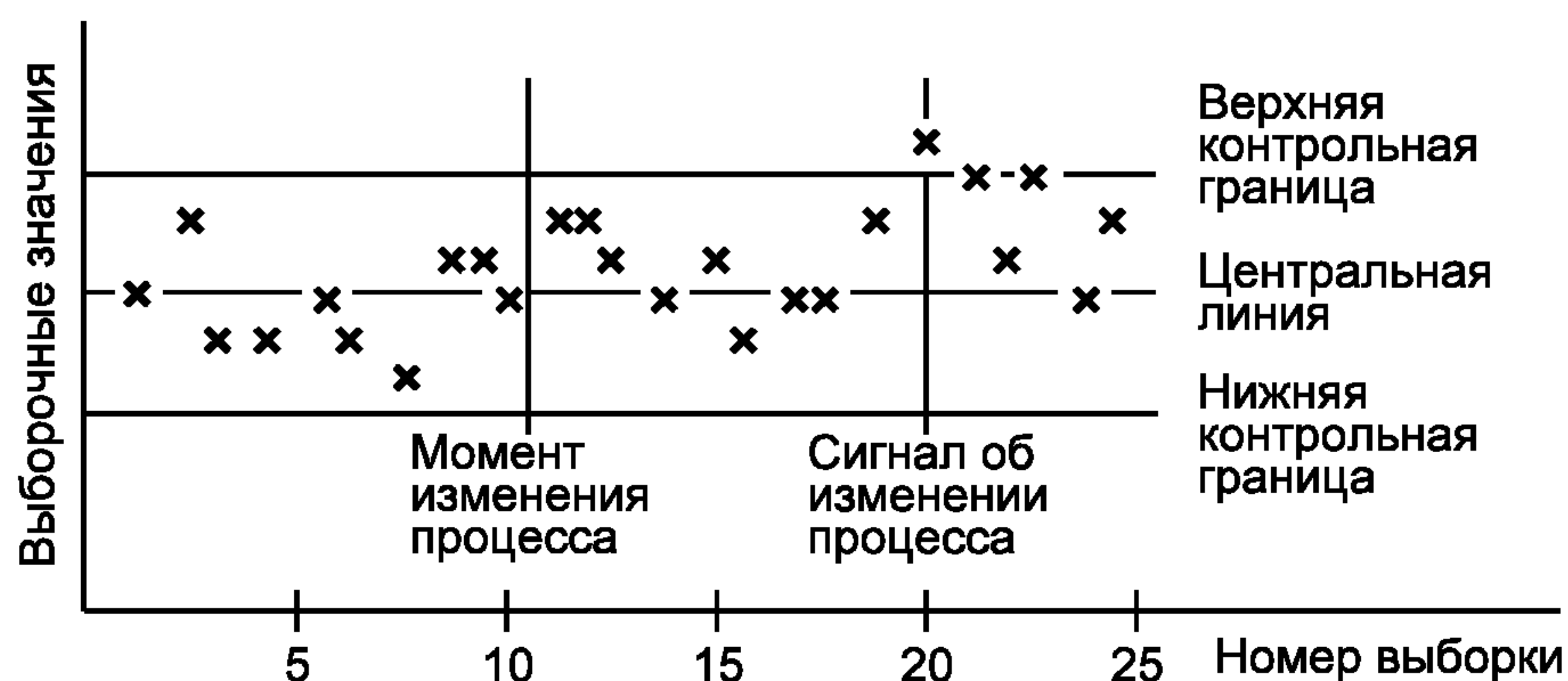
Рисунок 1 — Пример применения контрольной карты для случая, когда длина серии выборок равна 10 выборкам между моментом изменения процесса и сигналом об его изменении
