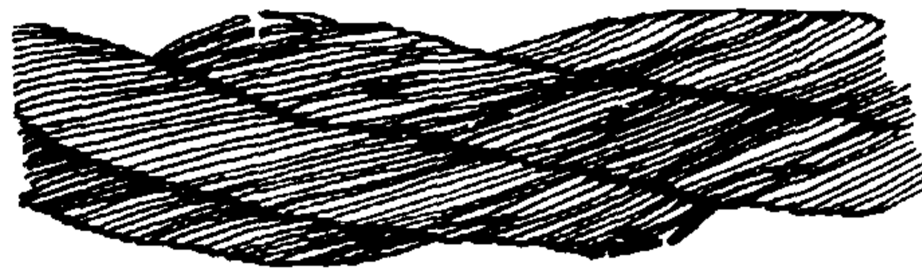
Рис. 1. Обрывы и смещения проволок каната крестовой свивки
