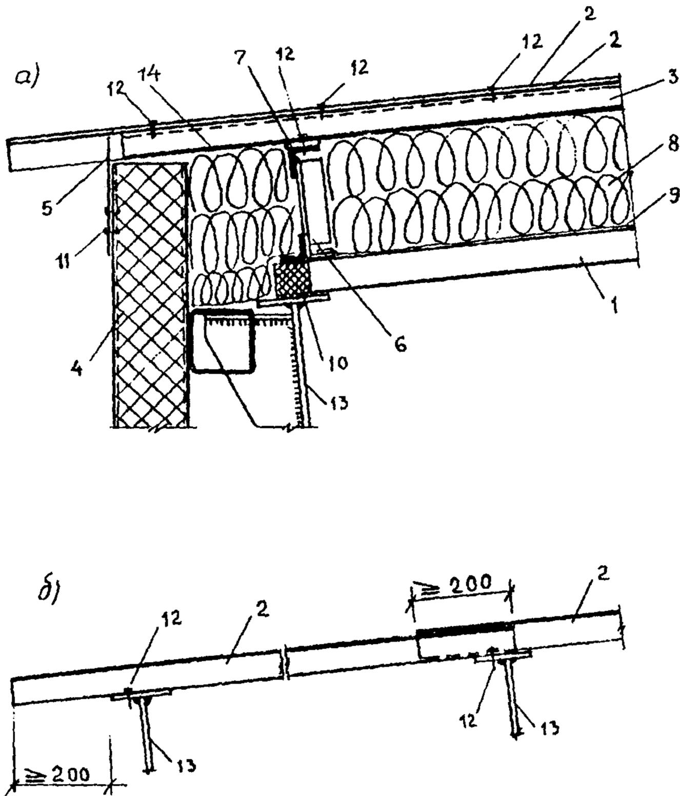
Рис. 26. Карниз кровли из металлического профнастила
