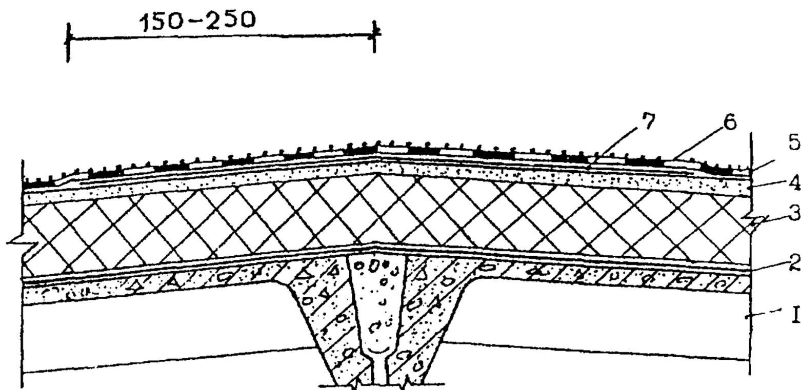
Рис. 7. Конек кровли
