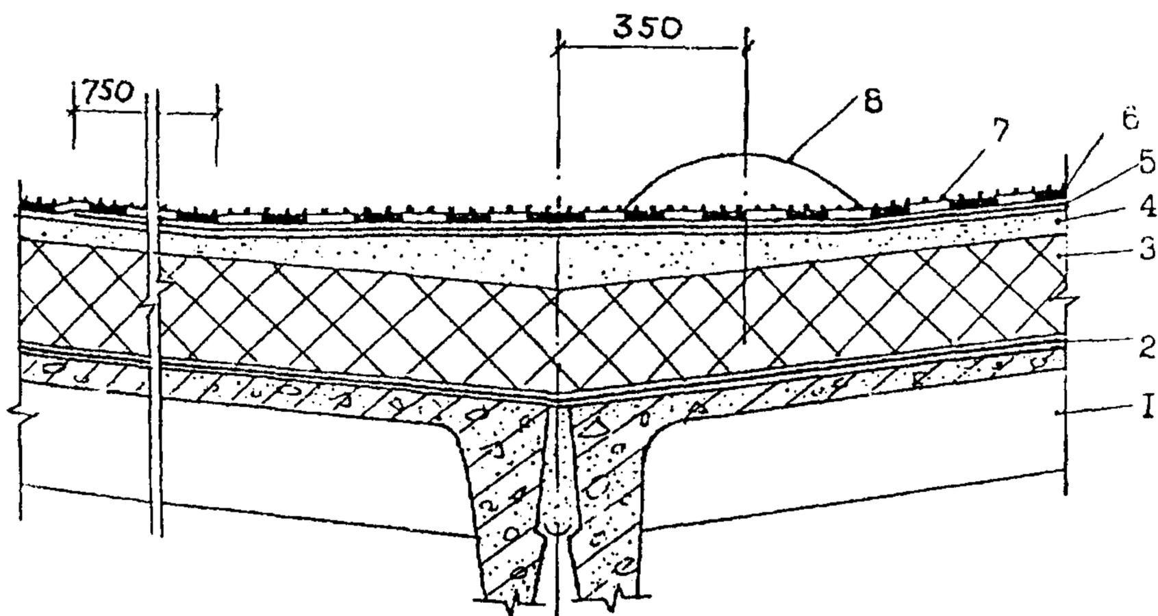
Рис. 8. Ендова кровли
