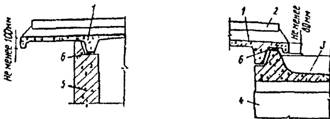
**Рис. 32.** Сливные свесы кровельной панели для крыш с наружным неорганизованным водоотводом
