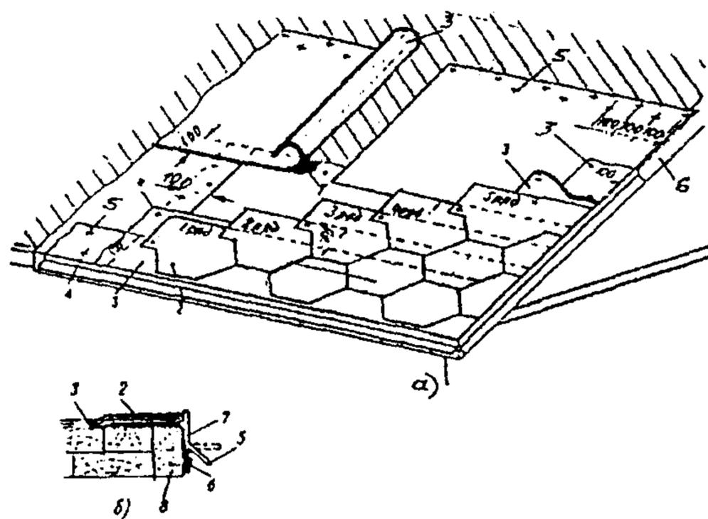
**Рис. 20. Конструктивное решение кровли из битумных плиток (шинглас)**
