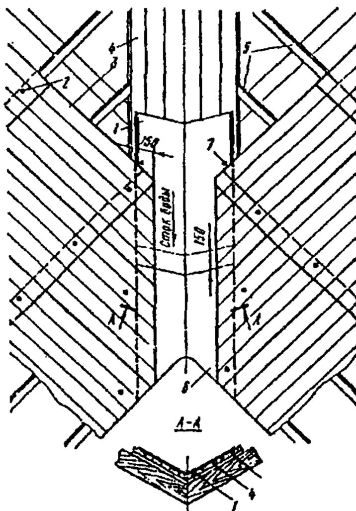
**Рис. 14. Устройство ендовы (разжелобка)**
