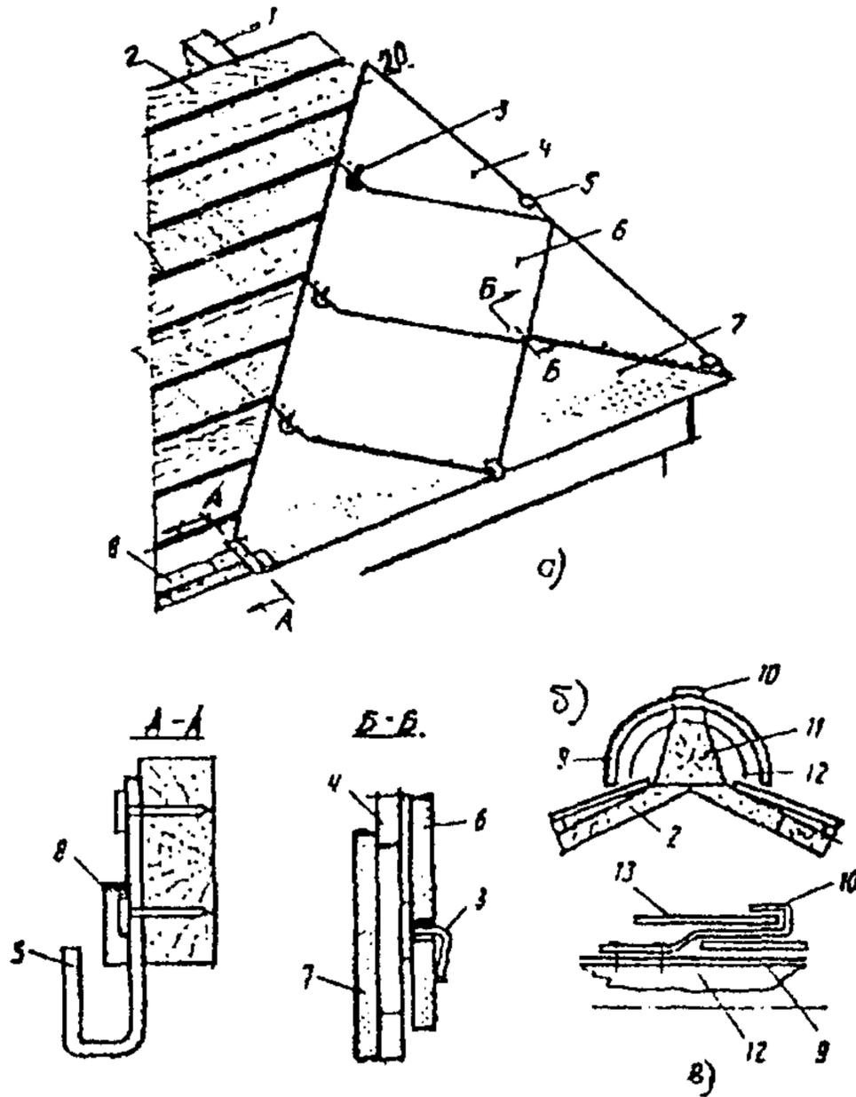
**Рис. 19. Конструкция кровли из асбестоцементных плоских плиток**
