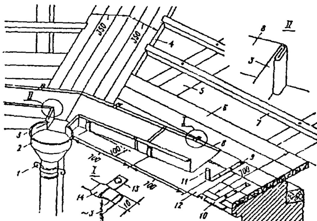
Рис. 24. Устройство настенного желоба
