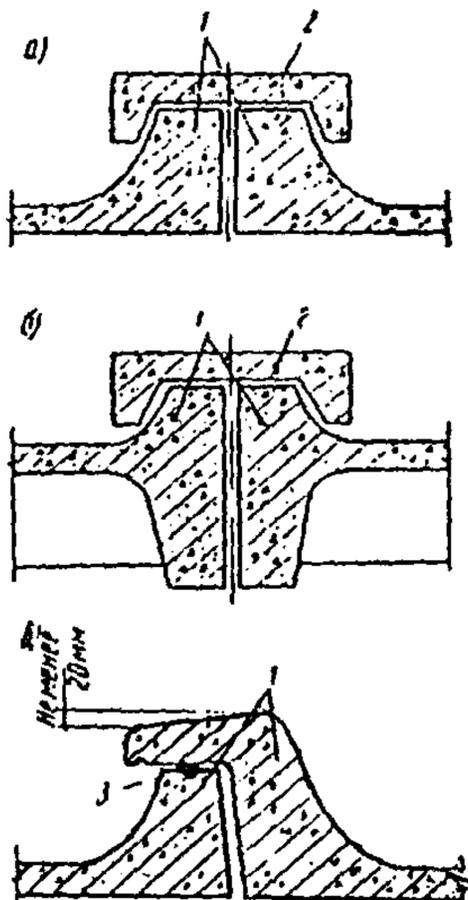
Рис. 31. Конструкции стыков кровельных панелей
