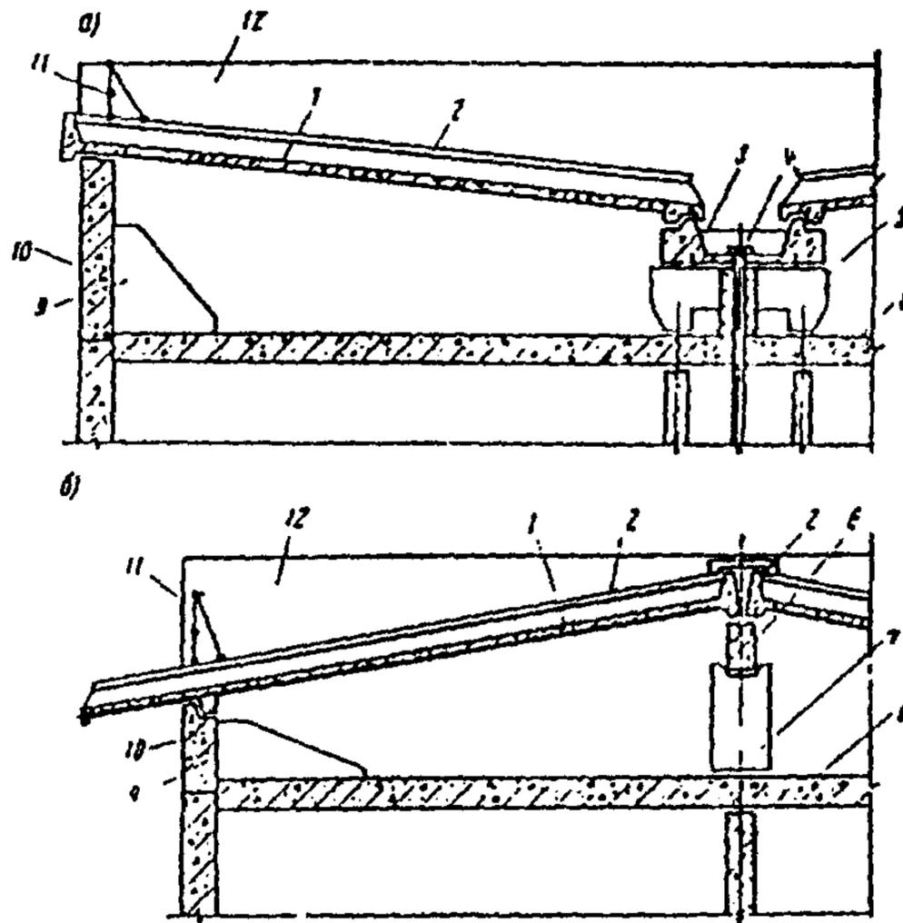
Рис. 30. Конструктивные схемы сборных железобетонных безрулонных крыш
