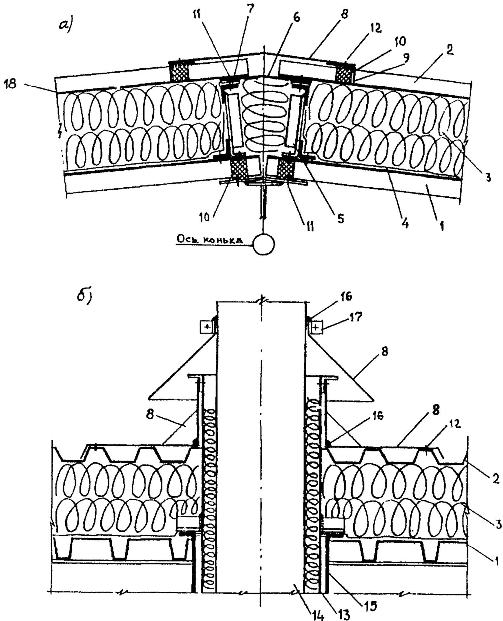
Рис. 27. Кровля из металлического профнастила
