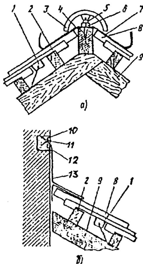
**Рис. 21.** Узлы черепичной кровли
