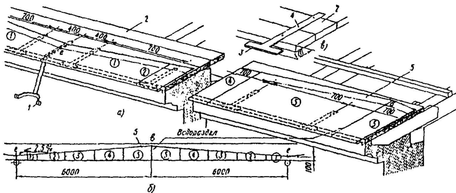
Рис. 23. Покрытие карнизного свеса
