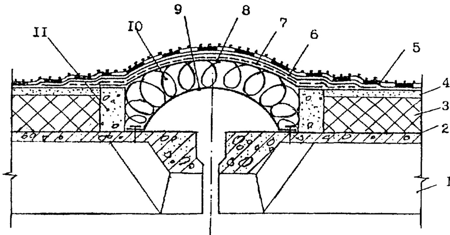
Рис. 4. Деформационный шов в покрытии
