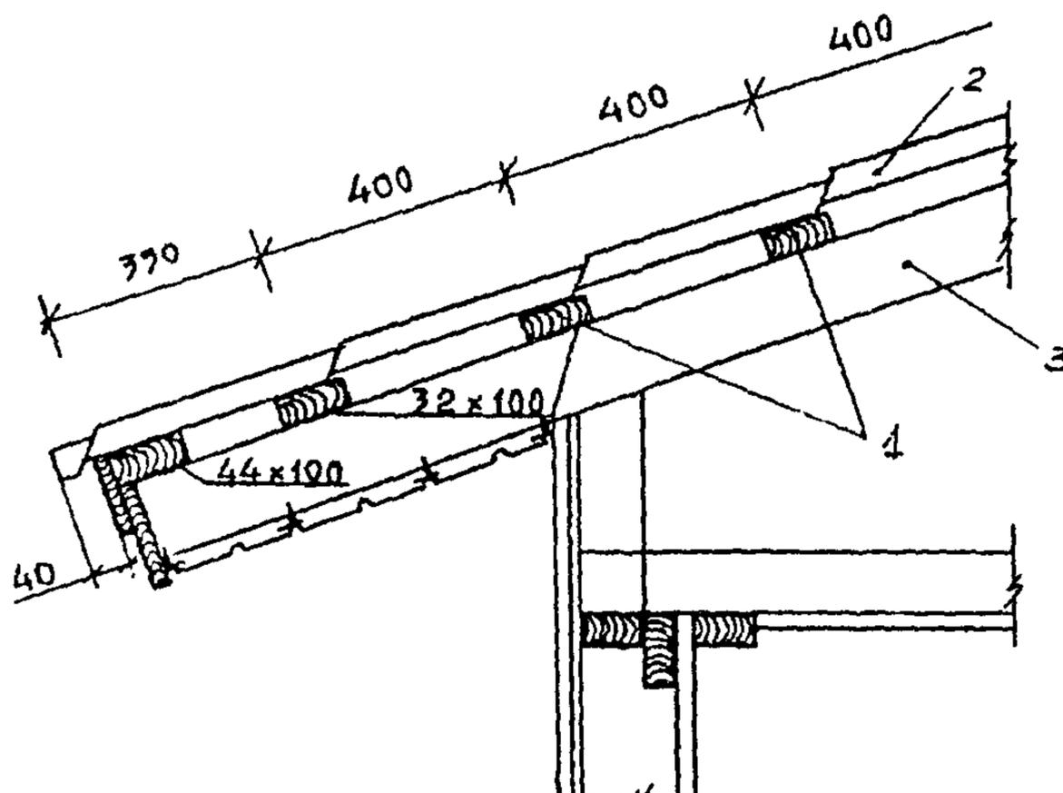
Рис. 29. Конструкция обрешетки под кровлю из металлочерепицы
