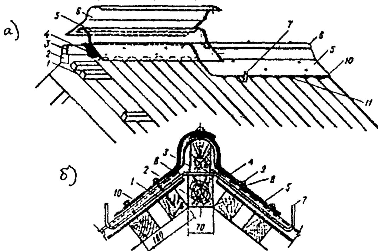
**Рис. 13. Покрытие конька (ребра)**
