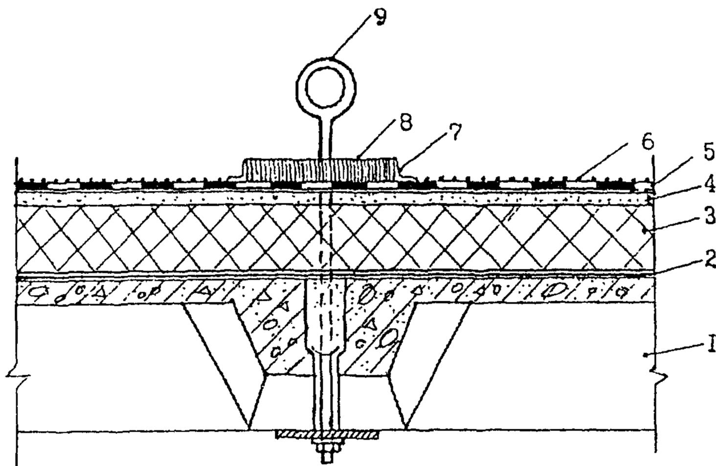
**Рис. 2. Пропуск анкера через водоизоляционный ковер**
