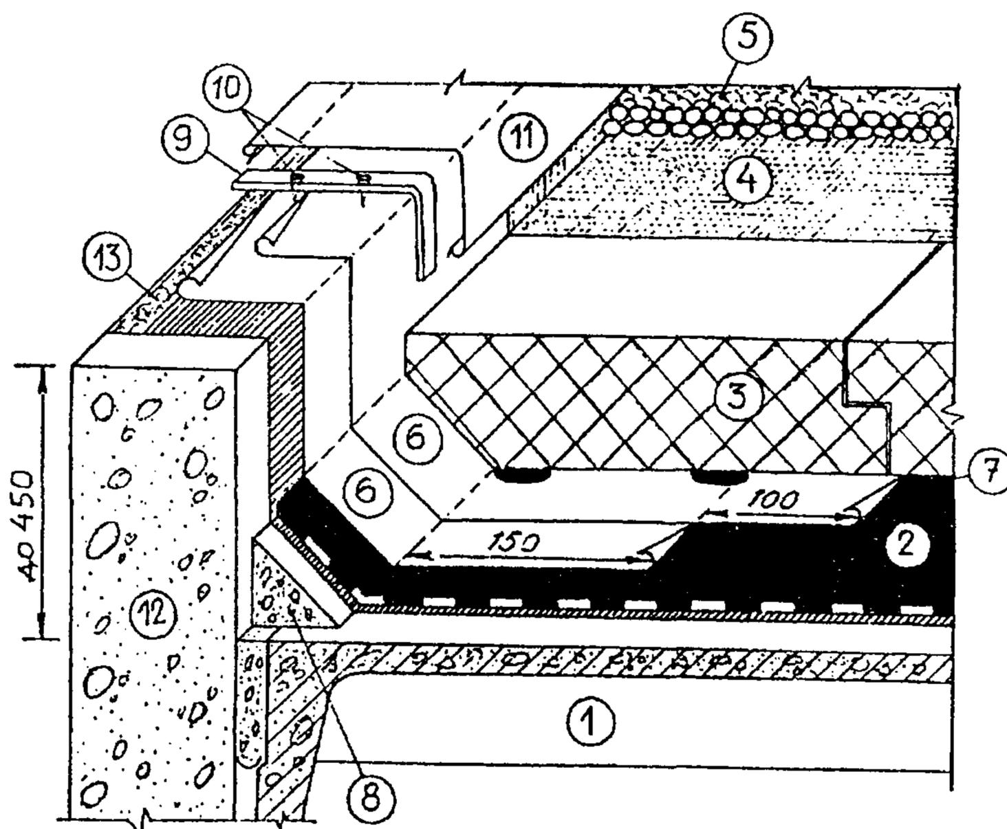
**Рис. 1. Инверсионная кровля с теплоизоляцией из экструзионного пенополистирола**
