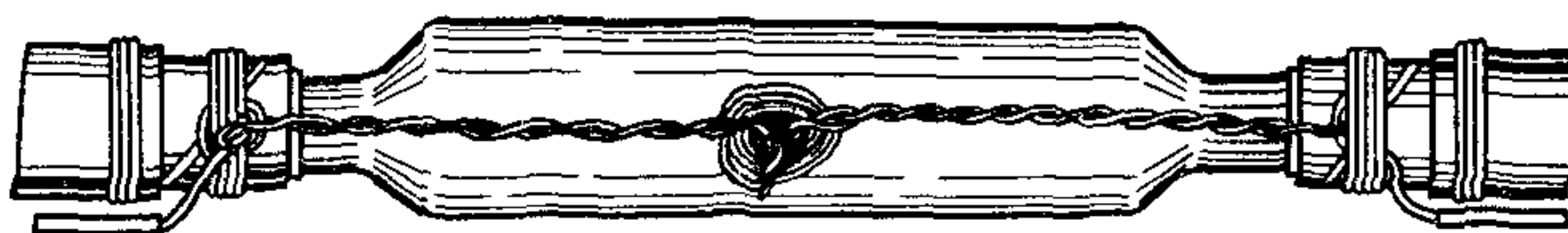
Рис. 10 41. Устройство перемычки между бронепокровами концов кабелей и свинцовой муфтой
