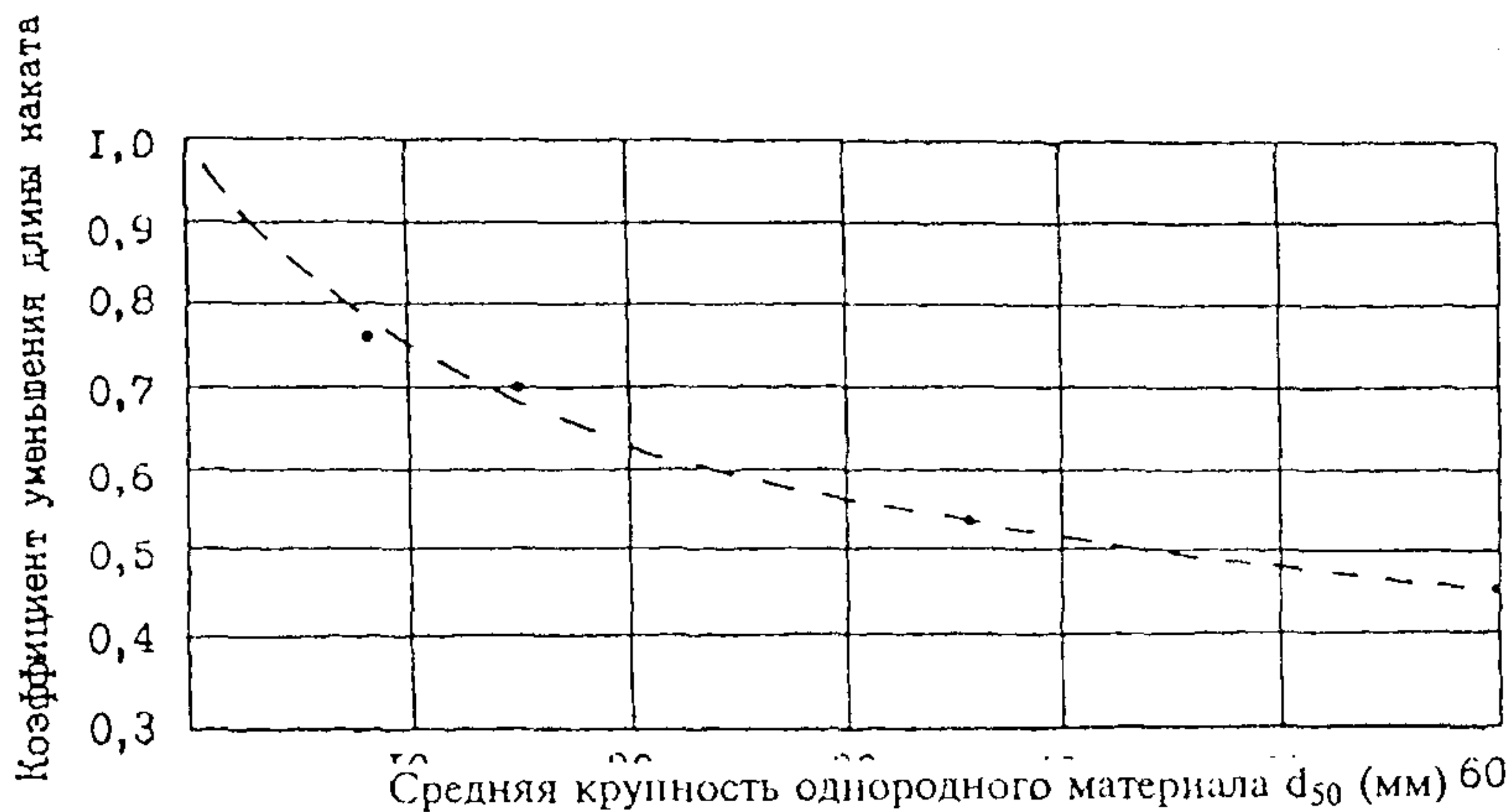
Рисунок 7.4 - Уменьшение длины наката в зависимости от крупности однородного материала
